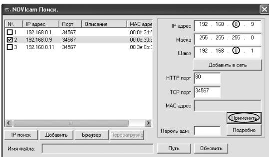
Рис. 5 Установка IP адреса.
