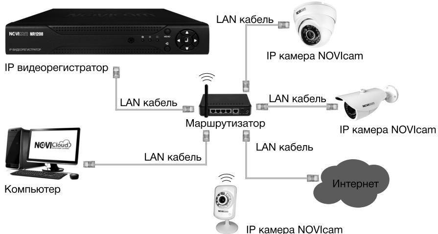
Рисунок 2. Пример подключения NR1208.
