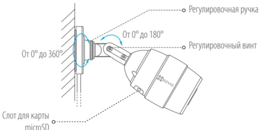
*i* При регулировке угла обзора камеры следите за тем, чтобы слот карты microSD был обращен вниз для защиты от проникновения воды.
