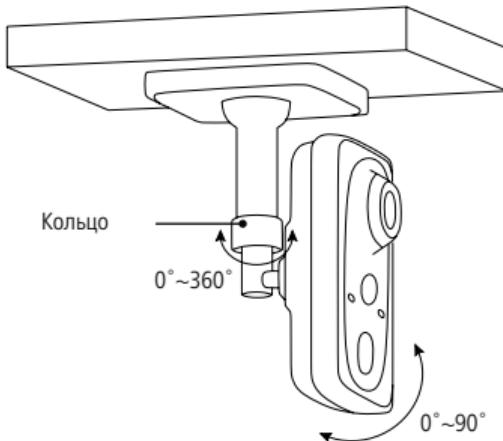
Рис. 18 Установка камеры NC24FP | NC34FP | NC44FP
