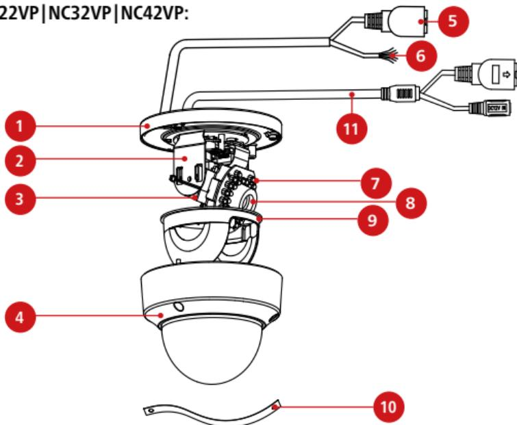
Рис. 4 Описание камеры NC22VP|NC32VP|NC42VP
