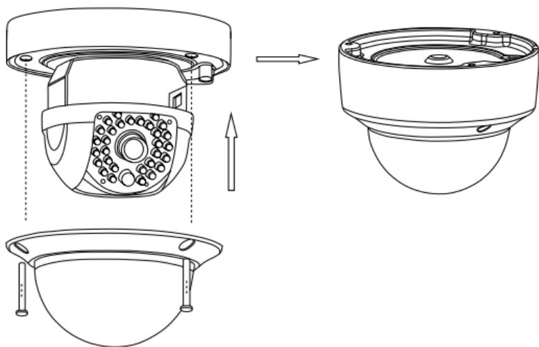
Рис. 21 Установка камеры NC28VP | NC38VP | NC48VP (шаги Д, Е)
