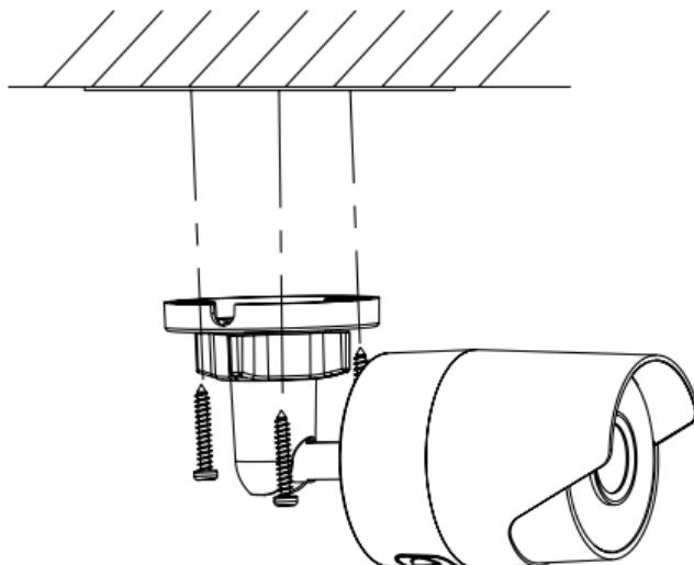
Рис. 12 Установка камеры NC23WFP | NC23WP
