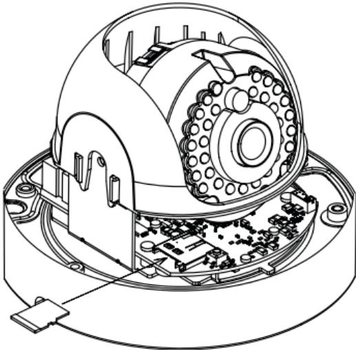
Рис. 19 Установка камеры NC28VP | NC38VP | NC48VP (шаги А,Б)
