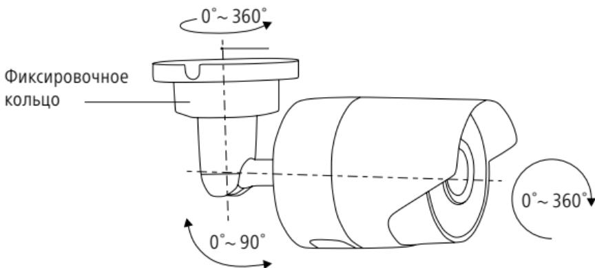
Рис. 14 Установка камеры NC23WFP | NC23WP
