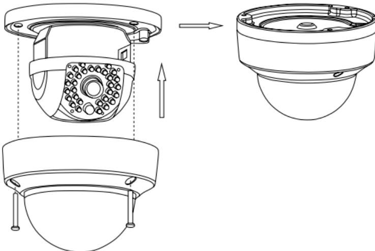
Рис. 11 Установка камеры NC22VP | NC32VP | NC42VP (шаги Ж,3)
