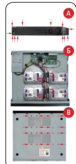
Рис. 3 Установка жесткого диска
