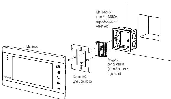
Рис. 3 Монтаж монитора видеодомофона MAGIC
