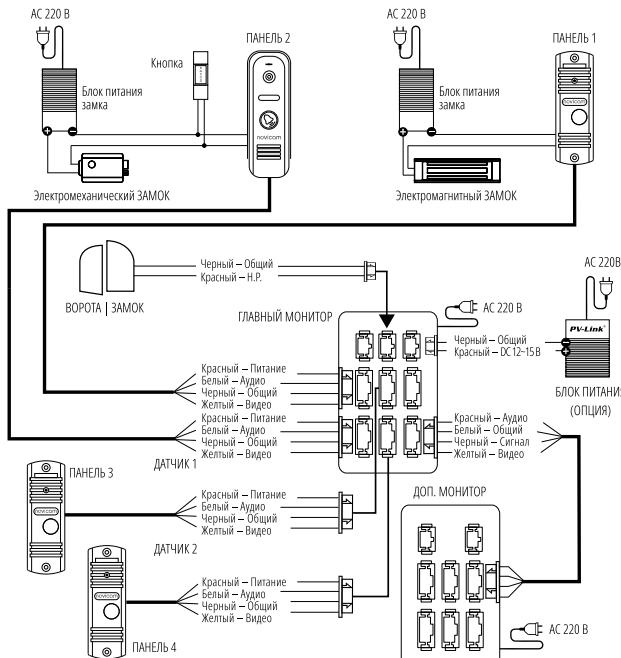
Рис. 8 Схема подключения видеодомофонов MAGIC 7 HD ver.4821|4822
