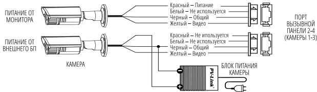
Рис. 9 Схемы подключения видеокамеры к монитору MAGIC HD
