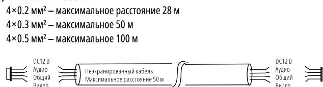
Рис. 4 4-х жильный кабель для подключения видеодомофона
