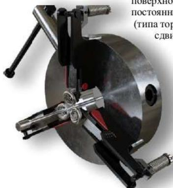
Упрочняющее обкатное трехроликовое устройство предназначено для упрочнения наружного поверхностного слоя цилиндрических деталей с постоянным или изменяющимся диаметром (типа торсионный вал). Ролики из штамповой стали сдвигаются в рабочую позицию с постоянным усилием. Максимальная твердость обрабатываемой детали 40 HRC. Устройство спроектировано для применения на универсальном токарном станке. Максимальное усилие обкатки 1.5 тонны.
