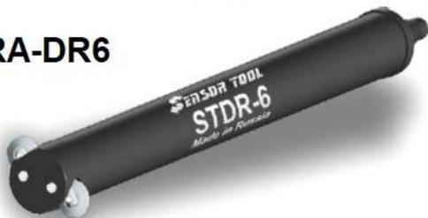
Упрочняющее пневматическое устройство для упрочнения поверхности внутренних цилиндрических и конических поверхностей. Усилие обкатки до 1 тонны. Ролики выполнены из штамповой стали. Применяется на универсальных токарных станках и станках с ЧПУ. Предусмотрена подача СОЖ в зону деформации через инструмент. Упрочненный слой на поверхности детали глубиной до 0,15 мм. Давление воздуха в системе 4-6 к/см<sup>2</sup> обеспечивается пневматической системой станка либо подключением к компрессору.
