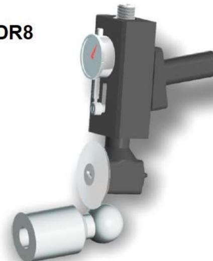
Упрочняющий накатной однорولیковий інструмент RA-DR для обработки цилиндрических валов, деталей сферической и конической формы оснащен специальным роликом с угловым профилем для накатки радиусов. Угол наклона ролика может составлять 45° или 90° и позволяет обрабатывать весь радиус детали. Индикатор с круглой шкалой позволяет отслеживать значение усилия накатки и глубину натяга. Державки 16x16, 20x20, 25x25, 32x32.
