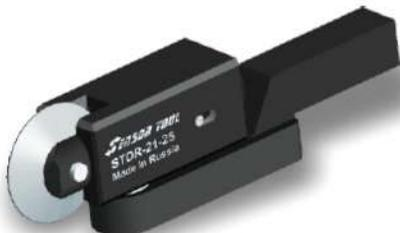
Универсальный упрочняющий поворотный роликовый обкатчик (УУПРО) для наружных поверхностей роликами устанавливается в револьверной головке токарного центра с ЧПУ или инструментальной стойке на универсальном токарном станке. Поверхности деталей обрабатываются с точностью до Ra 0,1 с использованием скоростей, соответствующих методам финишной обработки. Максимальное усилие пружины 120-140кг (1200-1400 Н) Инструмент выпускается в нескольких вариантах
