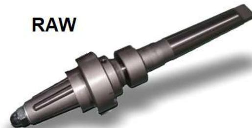
Вальцовка типа RAW предназначена для обкатывания стенок конусного отверстия с общим углом конусности 7 гр в плите толщиной 30-40 мм. Диаметры выхода роликов вальцовки в самом широком месте конуса - 29,5-30,7 мм. Обработки осуществляется путем вращения заготовки или вальцовки. Усилие, с которым следует поджимать веретено, должно быть минимальным, так как вальцовка является самозатягивающейся. Ролики выполнены из быстрореза.
