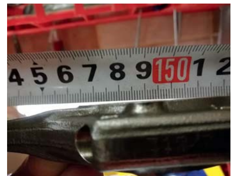
Рис.7. Загнутый в следствии детонационной перегрузки шатун.
