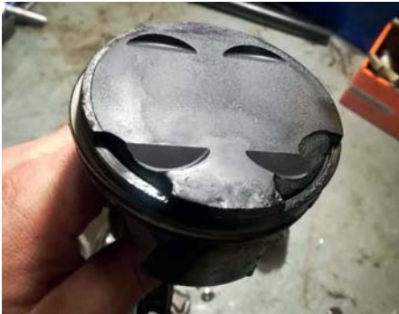
Рис.5 Разрушение огневых поясов в следствии детонации
