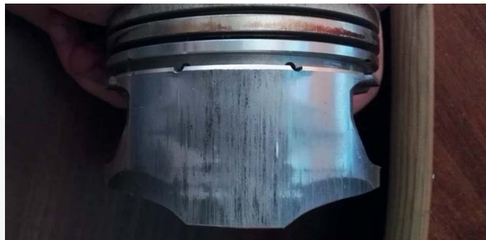
Рис.2 .Следы перегрева поршней в начальной стадии в следствии недостаточного теплового зазора. Черные следы, это локальное расплавление юбки поршня, но еще без налипания расплавленного материала на стенки цилиндра.
