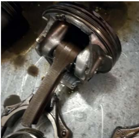
Рис.8 Разрушенные поршень и шатун 2-го цилиндра.
