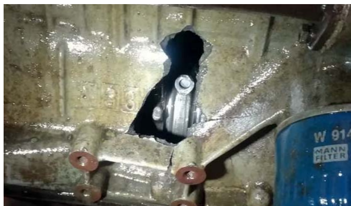
Рис.4 Разрушение блока цилиндров в следствии обрыва шатуна.
