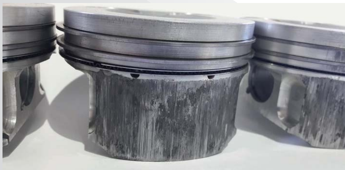
Рис.1 Следы сильного перегрева поршней с нагаровкой материала поршней на стенки цилиндра в следствии недостаточного теплового зазора.
