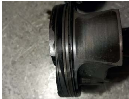
Рис. 6. Поврежденный детонацией поршень.
