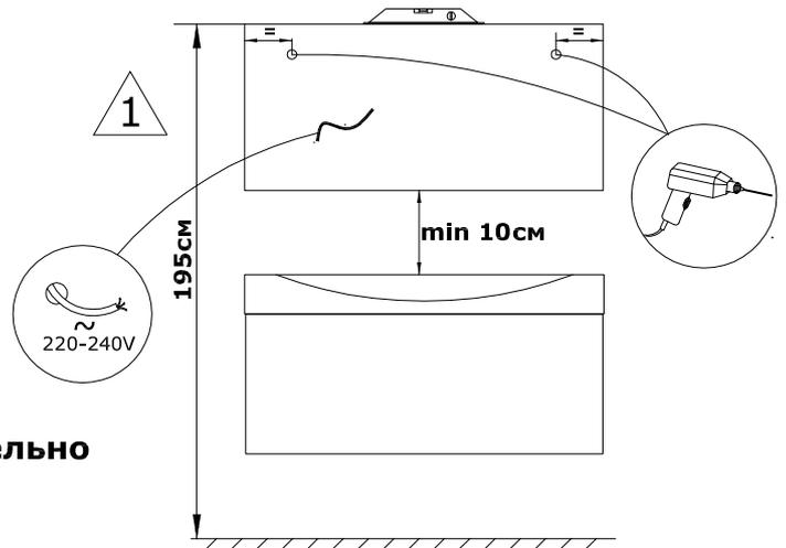
2. Навесьте зеркало на крюки, предварительно соединив электропроводку.
