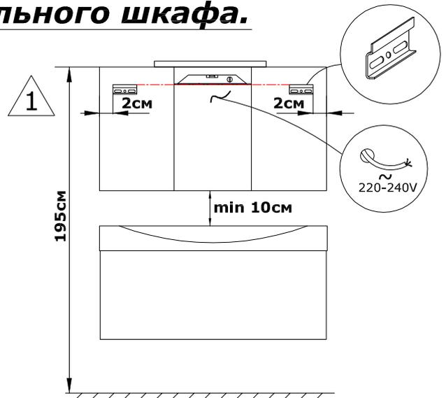
2. Закрепите на шкафу светильник(и) используя шурупы из комплекта фурнитуры.
