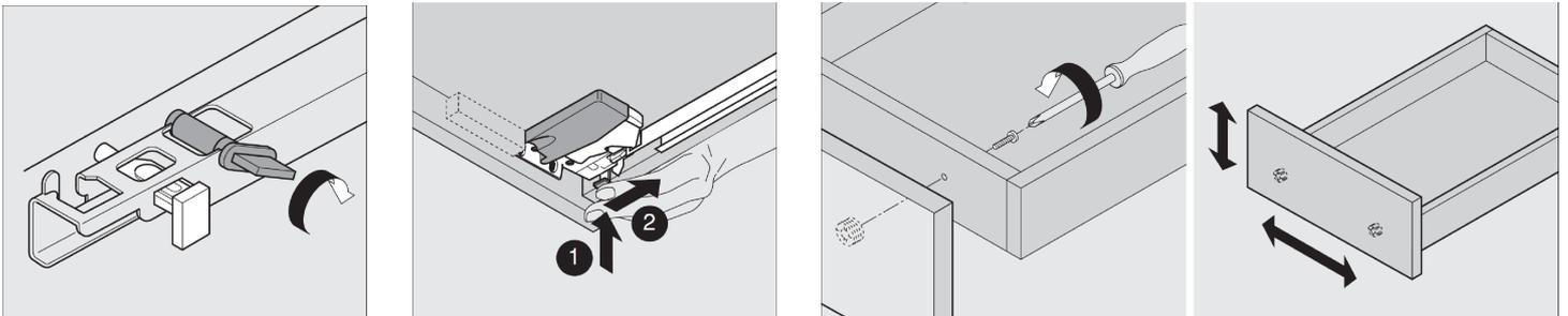
**После регулировки окончательно зафиксируйте положение фасада, вкрутив шурупы из комплекта фурнитуры в соответствующие отверстия в передней стенке ящика.**
