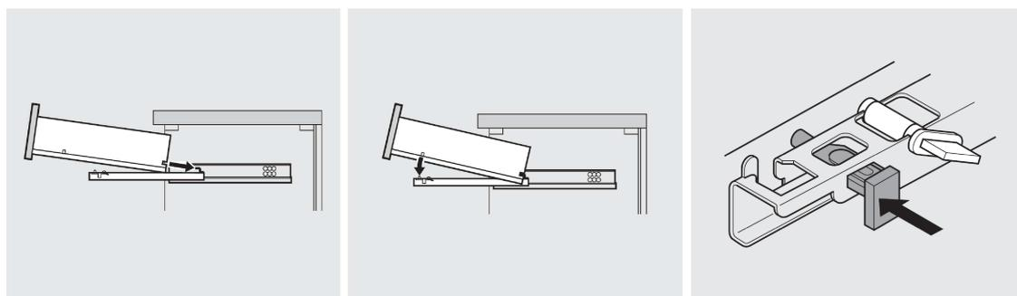
9. Если требуется, произведите регулировку фасада ящика. Для этого ослабьте винты, крепящие фасад ящика, произведите регулировку и затяните винты. Окончательно зафиксируйте положение фасада, вкрутив шурупы из комплекта фурнитуры в соответствующие отверстия в передней стенке ящика.
