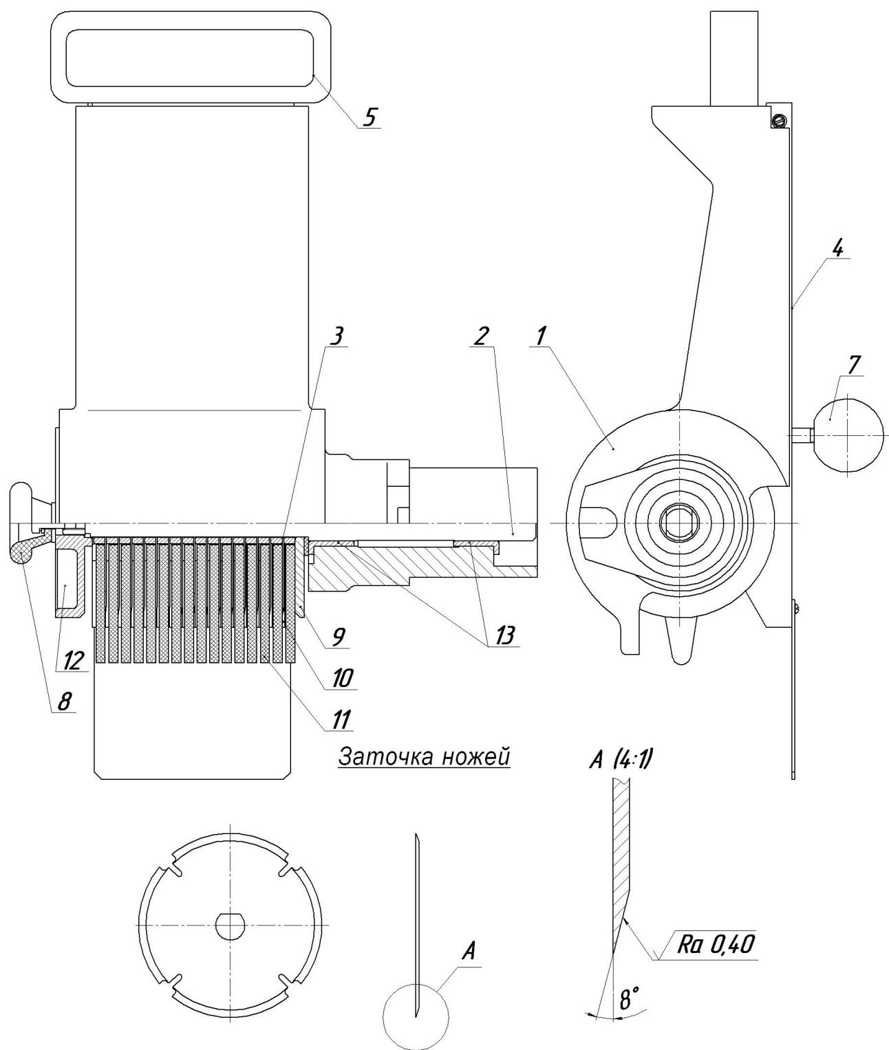
**Рисунок 25 – Механизм для нарезания мяса на бефстроганов**
