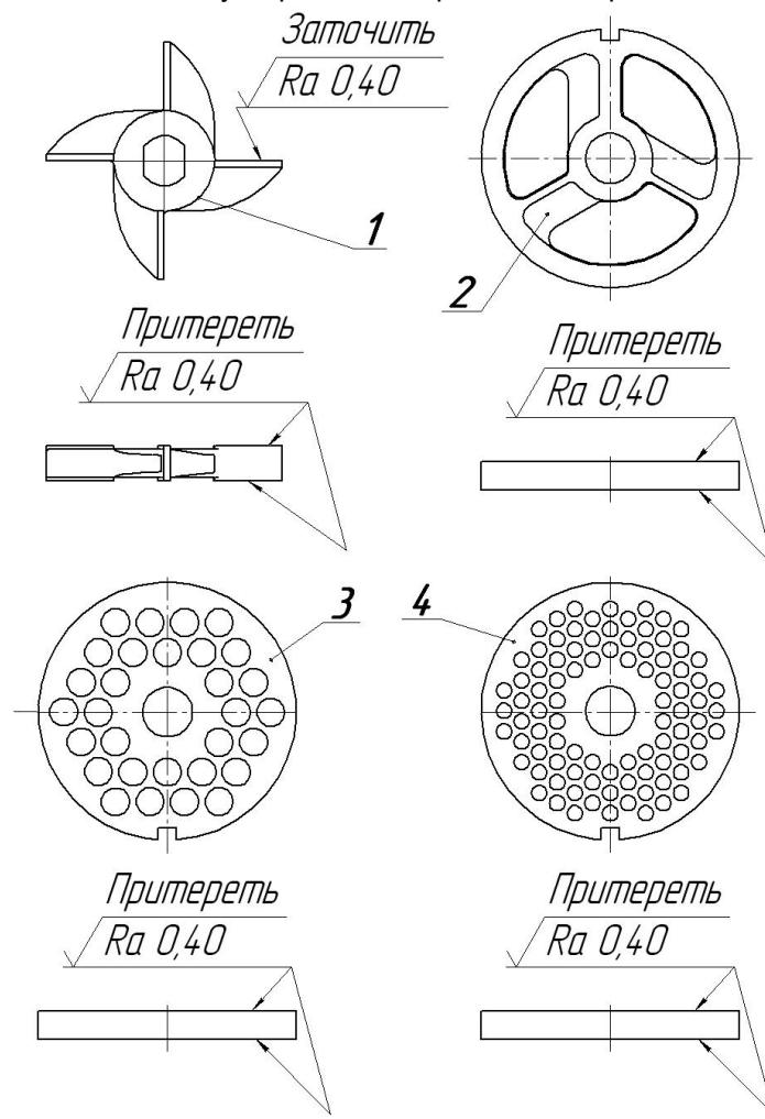
**Рисунок 5 – Нож и решетки мясорубки ММ**
