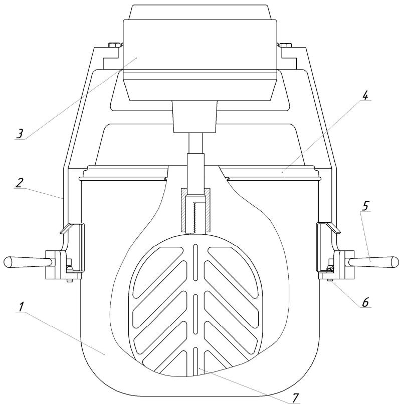
**Рисунок 6 – Механизм для взбивания и перемешивания ВМ**
