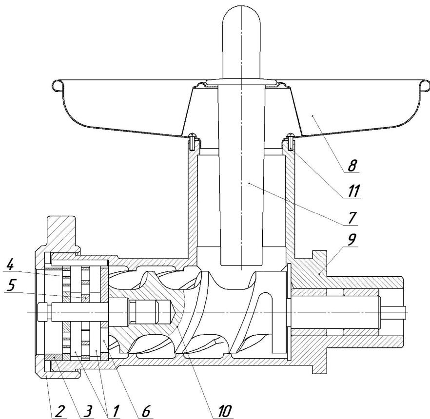
**Рисунок 2 – Мясорубка ММ**
