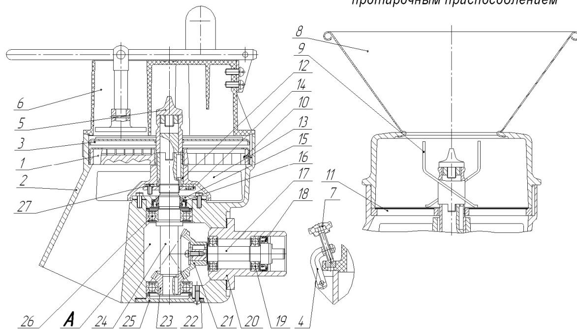
**Рисунок 10 – Механизм овощерезательно - протирочный МО**
