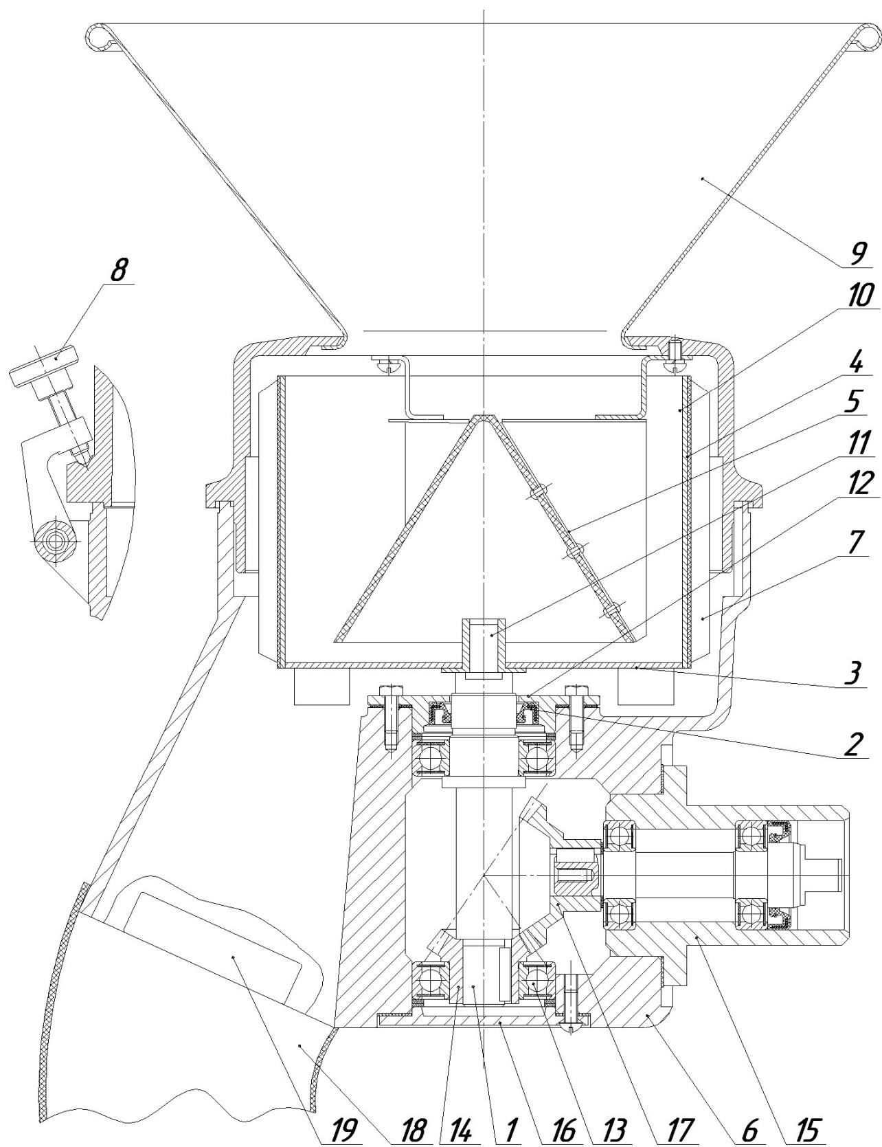
**Рисунок 19 – Просеиватель МП – 01**
