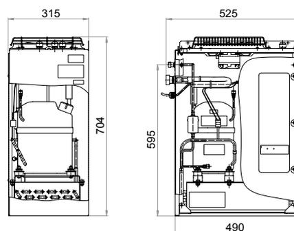
Габаритные размеры внешнего блока (ШхГхВ), мм:
