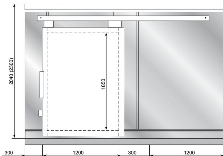
**Размеры дверного блока определяются шириной боковых панелей: 300, 600, 900, 1200 мм.**
