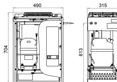
Габаритные размеры внешнего блока (ШхГхВ), мм:
