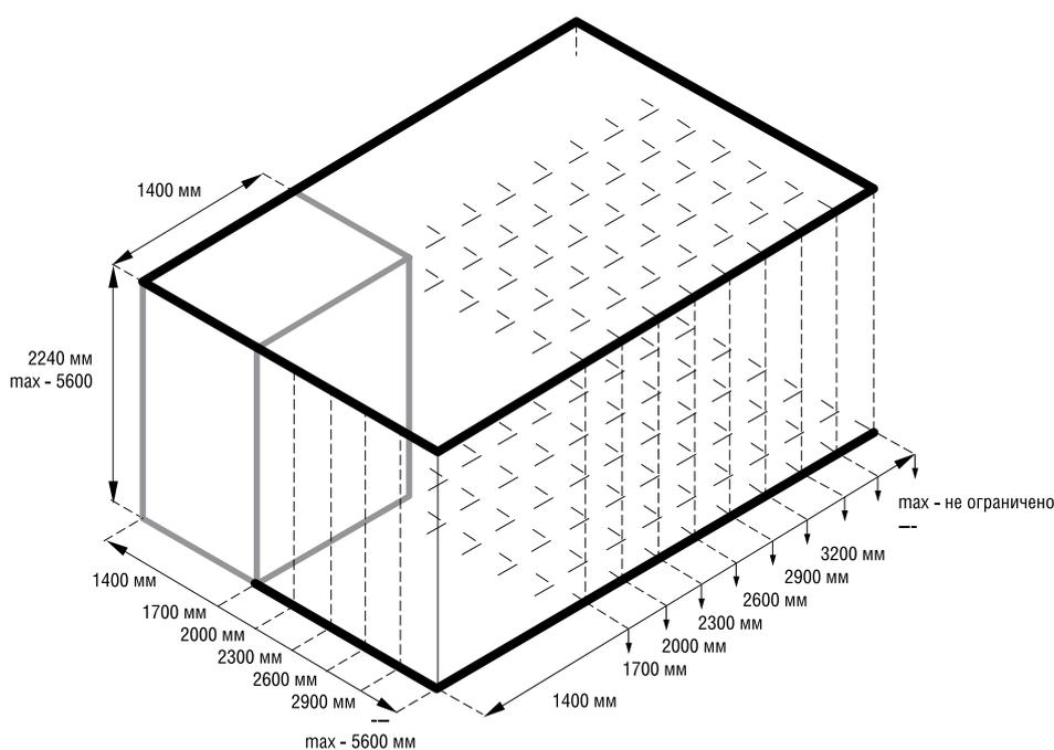
**Соответствие внутреннего объема (м<sup>3</sup>) и внешних размеров камер POLAIR Professionale при высоте 2240 мм**
