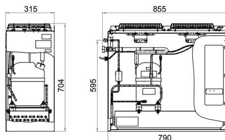
Габаритные размеры внешнего блока (ШхГхВ), мм:
