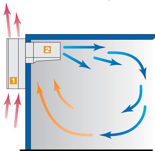
Сплит-система состоит из двух отдельных блоков, соединенных между собой медными трубками в теплоизоляции и кабелями питания и управления. Блоки сплит-системы можно размещать на некотором расстоянии друг от друга. Это позволяет использовать сплит-системы в случаях, когда толщина стен или размеры помещения, в котором находится холодильная камера, не позволяют установить моноблоки.
