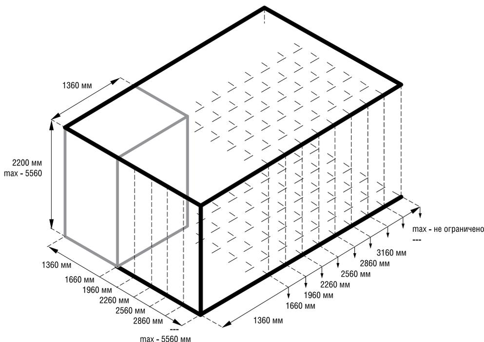
**Соответствие внутреннего объема (м³) и внешних размеров камер POLAIR Standard при высоте 2200 мм**
