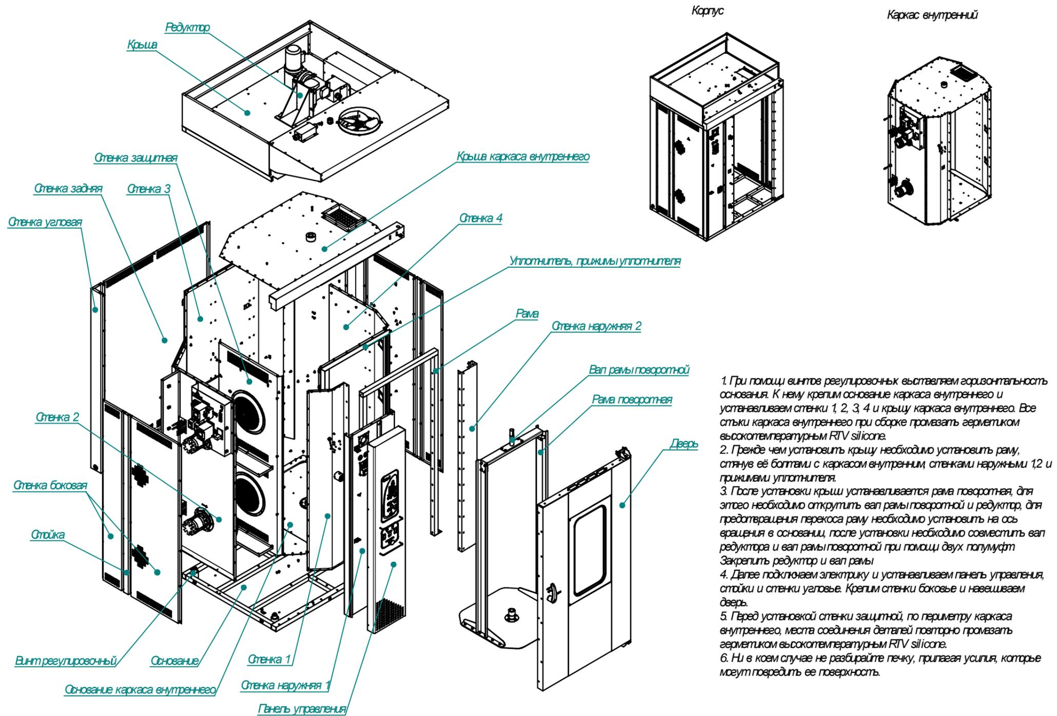
1. При помощи винтов регулировочных выставляем горизонтальность основания. К нему крепим основание каркаса внутреннего и устанавливаем стенки 1, 2, 3, 4 и крышу каркаса внутреннего. Все стыки каркаса внутреннего при сборке промазать герметиком высокотемпературным RTV silicone.
