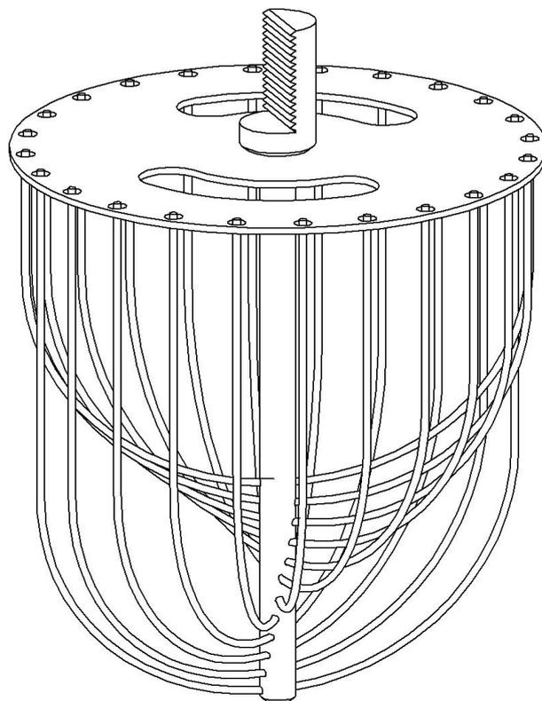
**Рисунок 9 – Взбиватель прутковый механизма ВМ**
