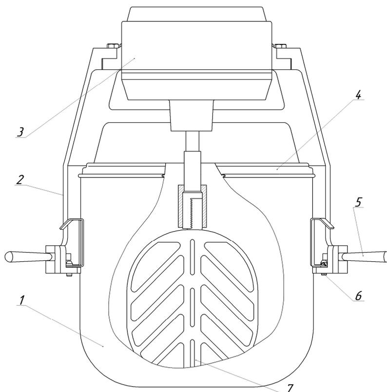
**Рисунок 6 – Механизм для возбуждения и перемешивания ВМ**
