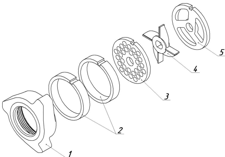
**Рисунок 4 – Набор для крупной резки мясорубки ММ**
