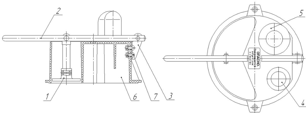
**Рисунок 11 – Приспособление загрузочное овощерезательное**
