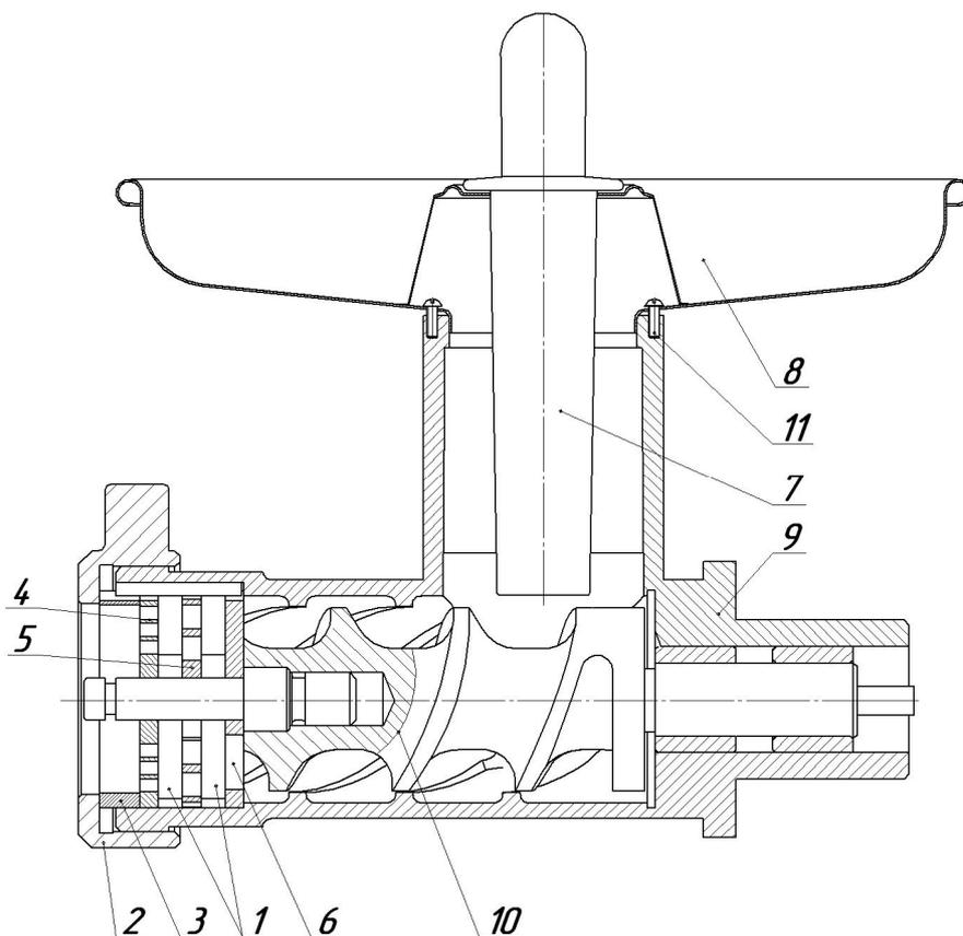
**Рисунок 2 – Мясорубка ММ**
