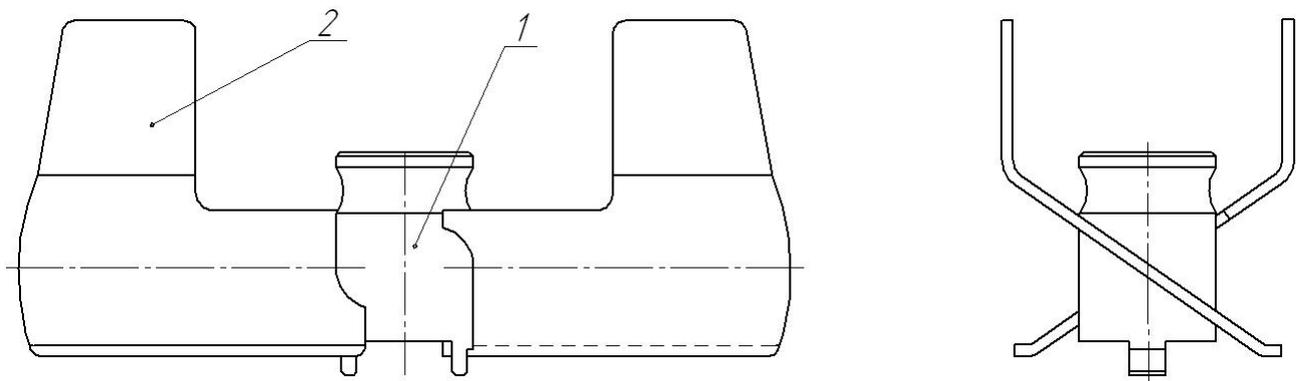
**Рисунок 15 – Ротор лопастной**
