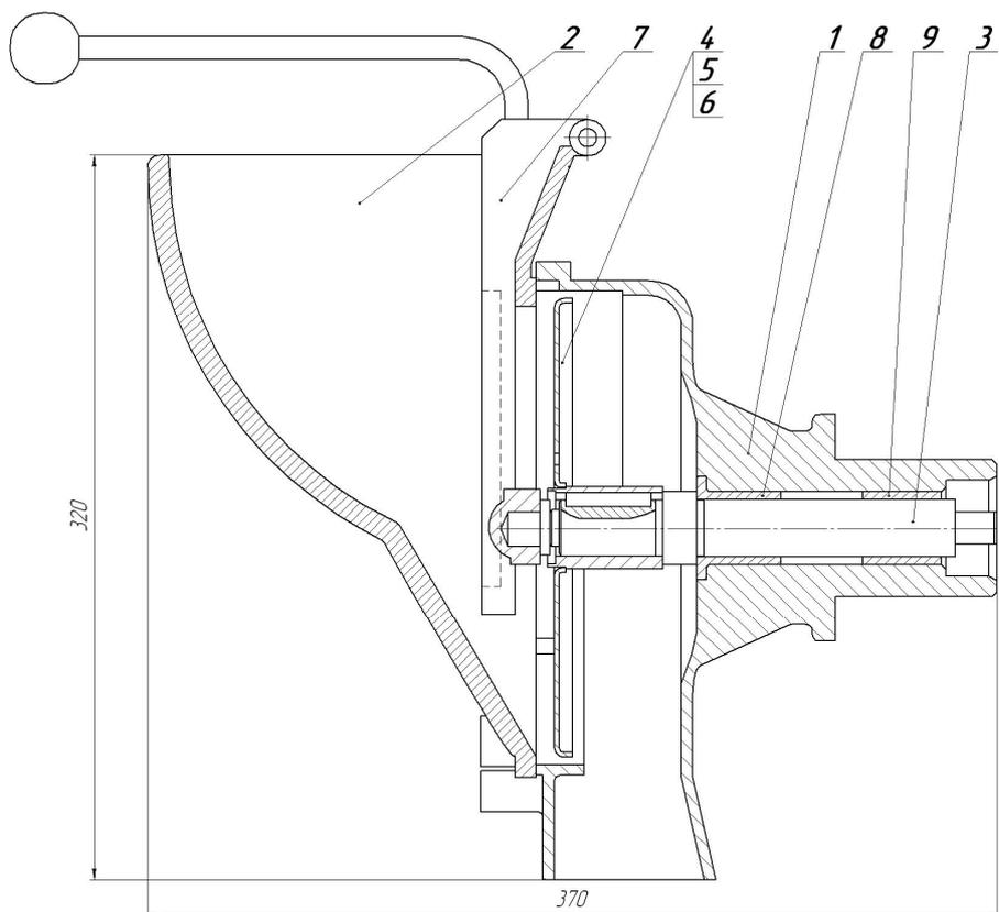
**Рисунок 31 – Овощерезательный механизм, механизма МО –1**
