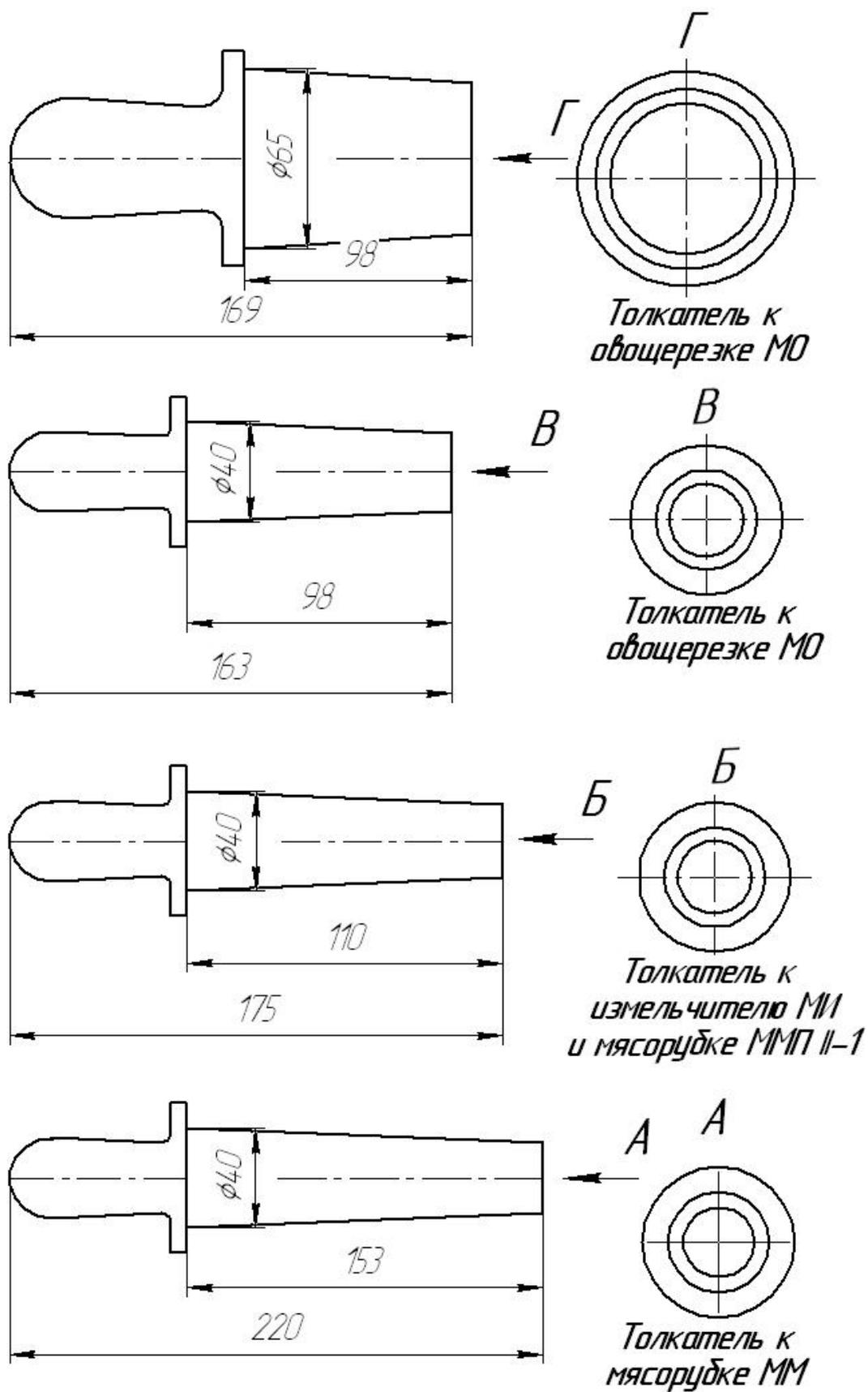
Рисунок 30 – Принадлежности к механизмам машины УКМ
