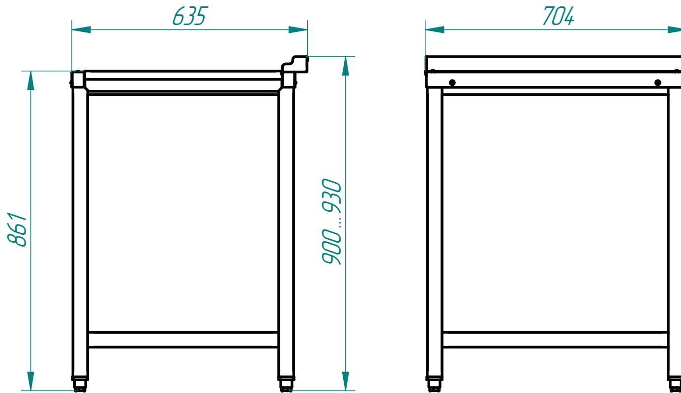
Стол раздаточный используется в комплексе с посудомоечной машиной, имеет регулируемые по высоте ножки (не менее 20 мм). Стол полностью разборный с обвязкой по четырем сторонам, изготовлен полностью из высококачественной нержавеющей стали. Путем несложного монтажа стол можно установить как в правом, так и в левом исполнении.
