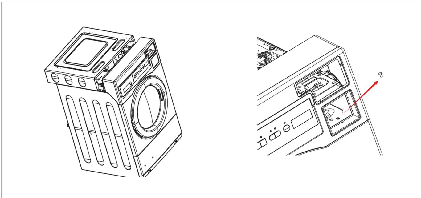
Выкрутите два болта верхней балки.
