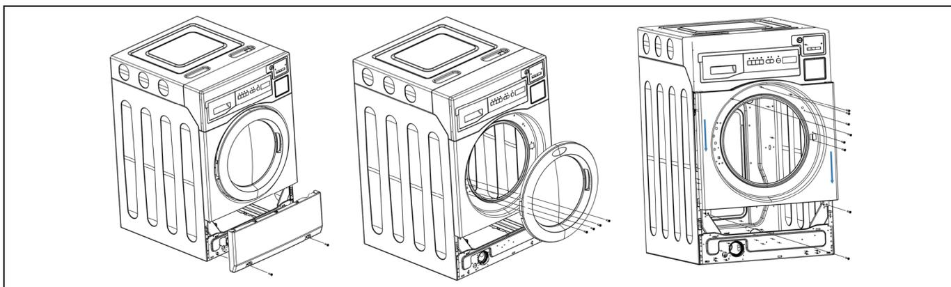
Снимите главную переднюю панель и отсоедините разъем замка дверцы люка.
