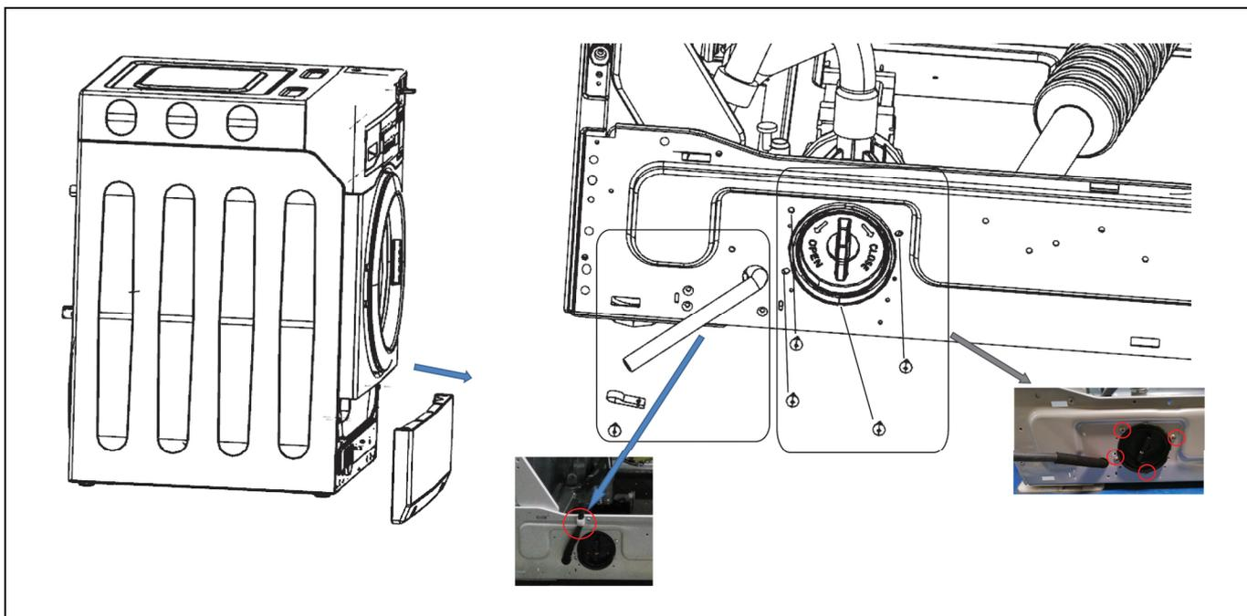
Снимите зажимы и снимите сливную трубу и шланг.
