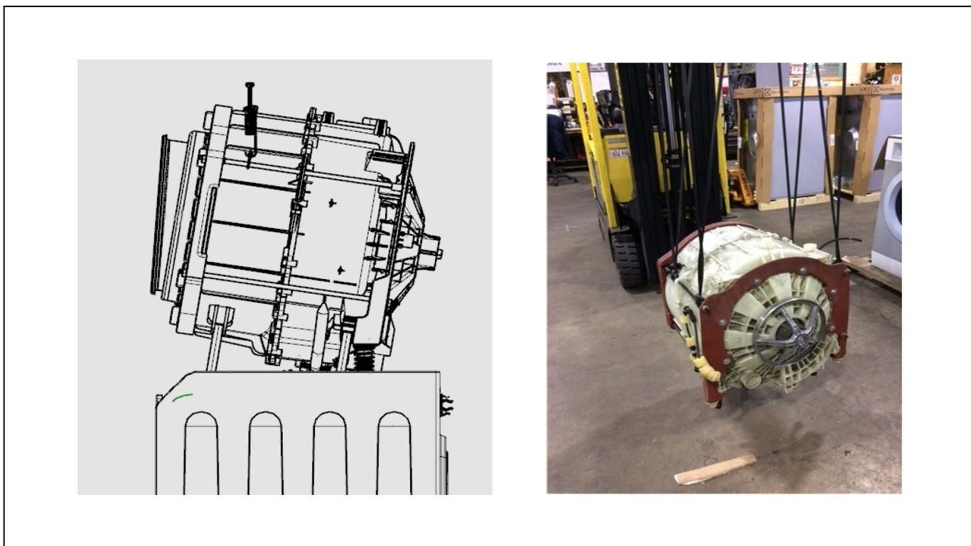
Снимите гайки верхней и нижней рейки. (Затяните гайку с моментом затяжки 14~16 Нм)
