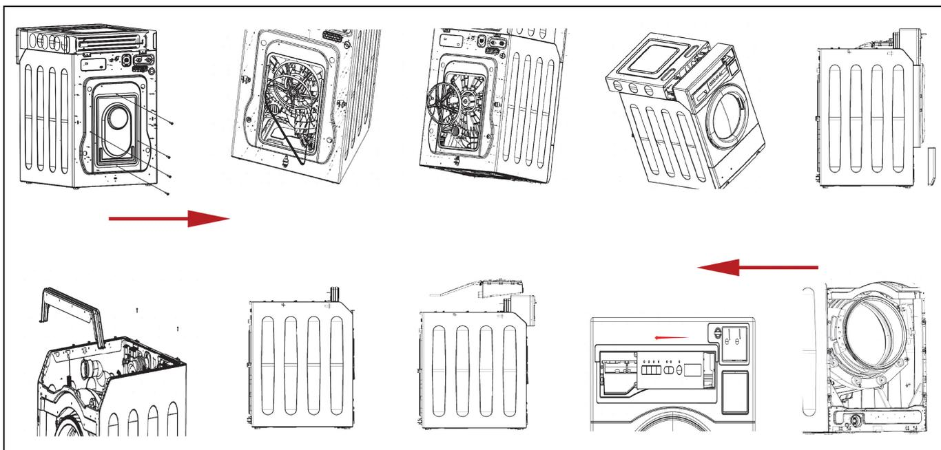
Снимите все электрические устройства и сливной насос.
