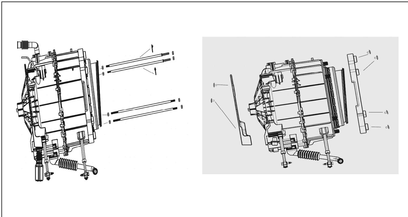
Отсоедините передний бак от заднего бака. Снимите внутренний барабан с заднего бака.
