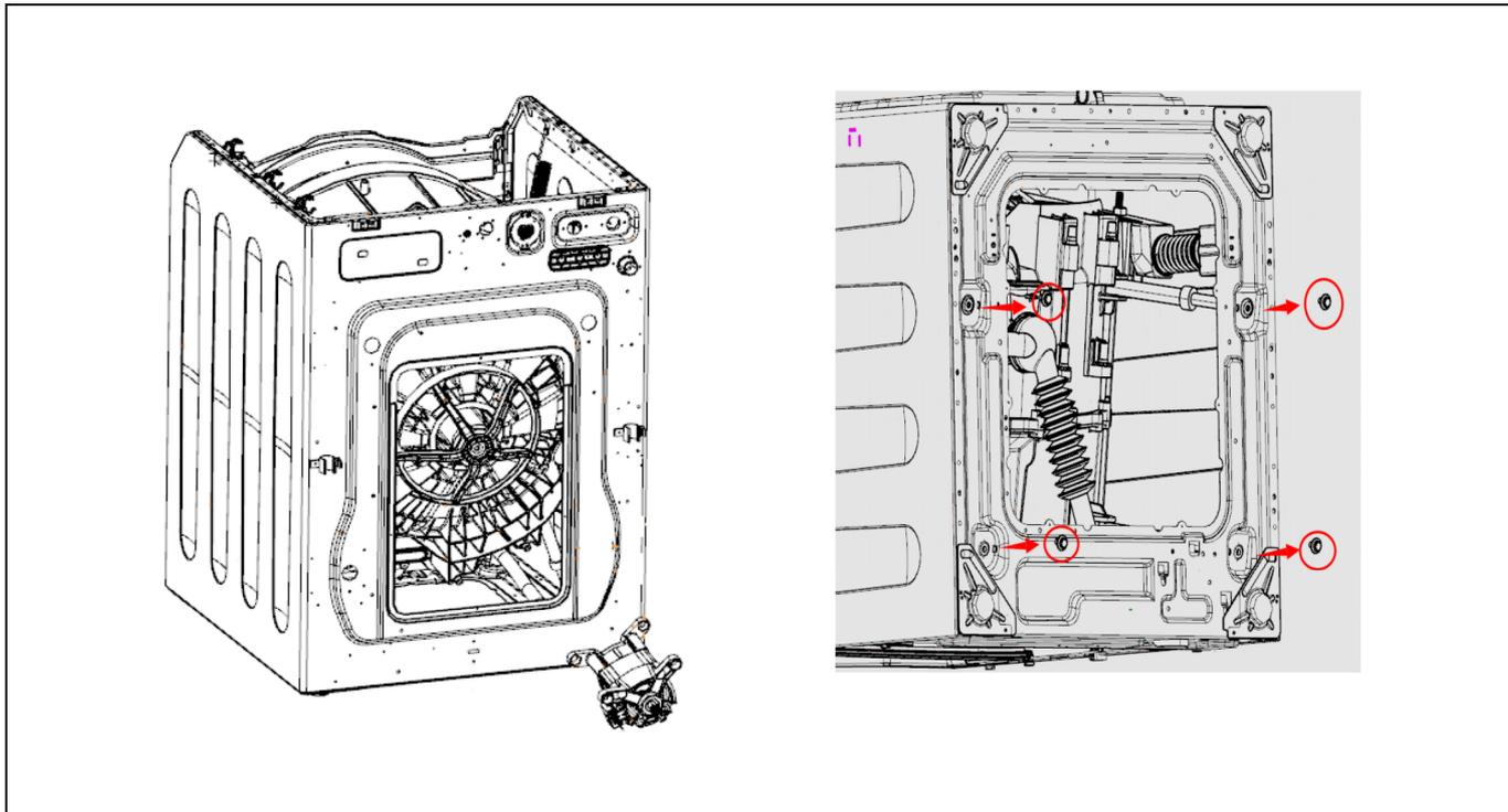
Вытащите барабанный модуль из корпуса.
