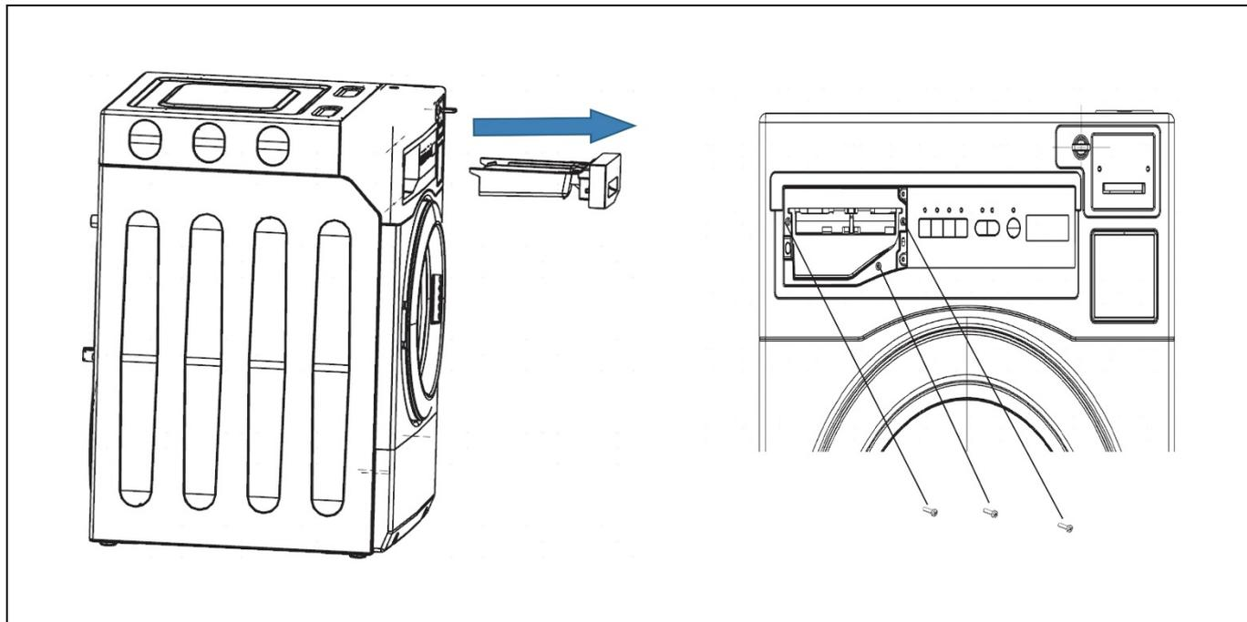
Снимите два винта между верхней балкой и лотком.
