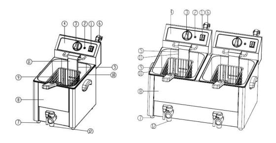
1. SWITCH 2. INDICATOR LIGHT 3 TEMPERATURE CONTROLLER
