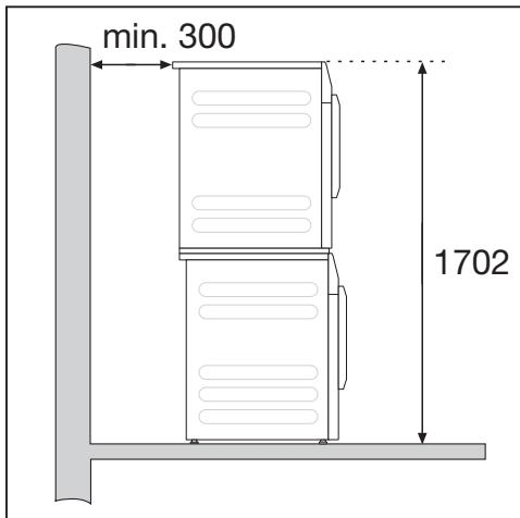
Стиральная машина может устанавливаться в колонну с сушильной машиной Miele. Для этого требуется монтажный комплект (для соедине-
