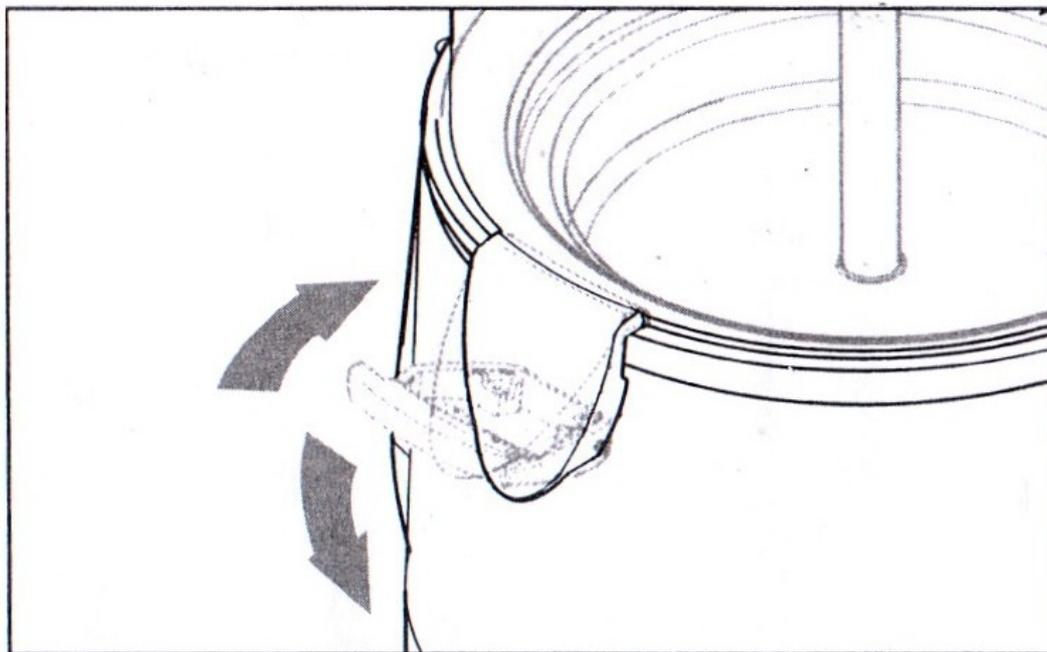
Поставьте чашу на корпус машины и пристегните ее с помощью креплений.
