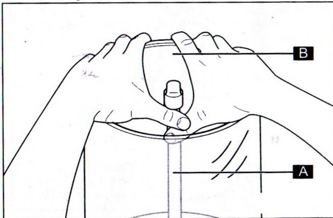
Осторожно снимите чашу с корпуса машины. При этом двумя пальцами удерживайте шнек.
