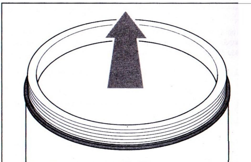
Поместите чашу на ровную поверхность и двумя руками снимите уплотнитель с резьбы чаша.
