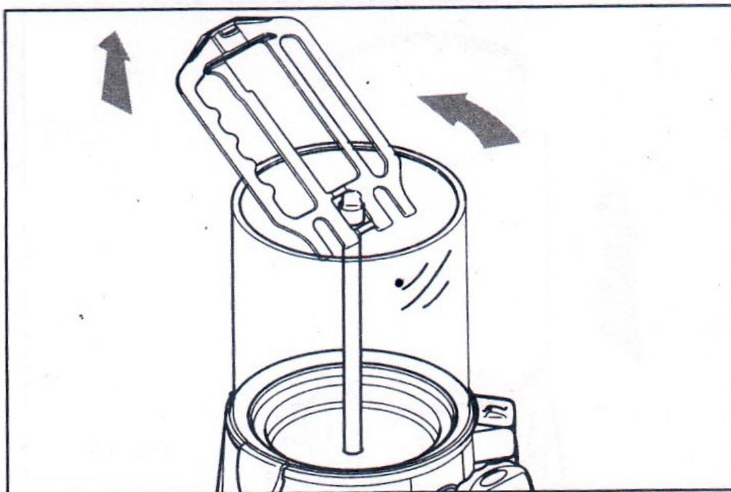
Наклоните смеситель и снимите его по направлению вверх, как показано на рисунке.
