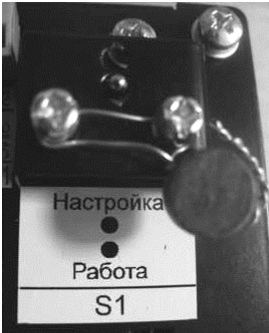
Рис.3. Пломбировка тумблера «Настройка/Работа» блока управления
