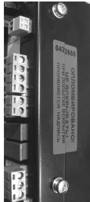
Рис.4. Пломбировка корпуса блока управления
