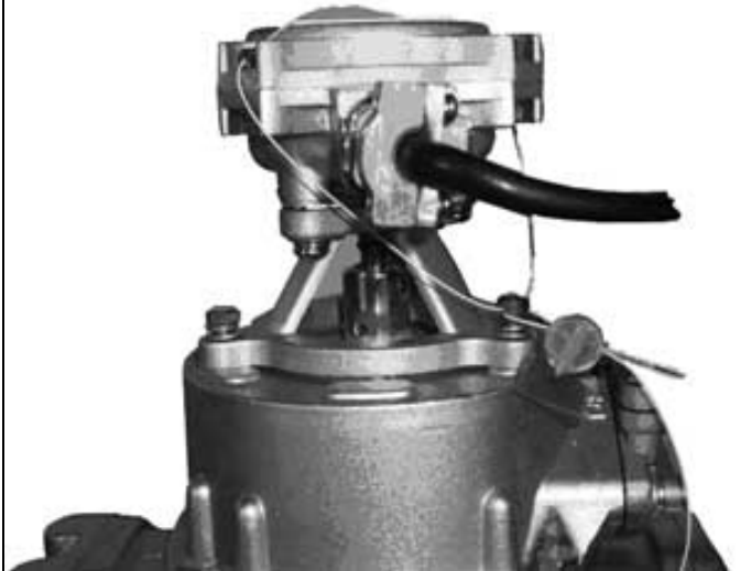
Рис.2. Пломбировка датчика расхода топлива
