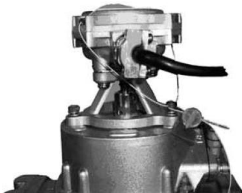
Пломбировка генератора импульсов
