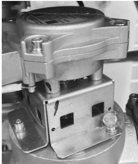
Рисунок В.1 Пломбировка генератора импульсов
