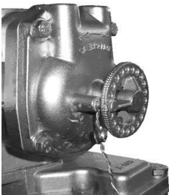
Пломбировка измерителя объема
