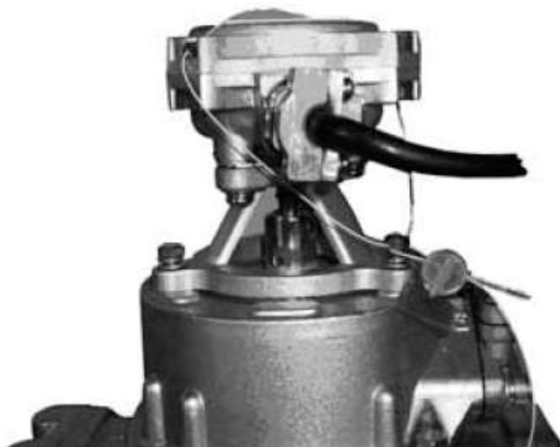
Пломбировка генератора импульсов
