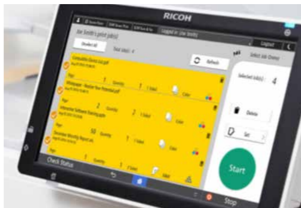
После авторизации на принтере сотрудник видит список своих заданий на печать. Он может напечатать некоторые из них или все.
