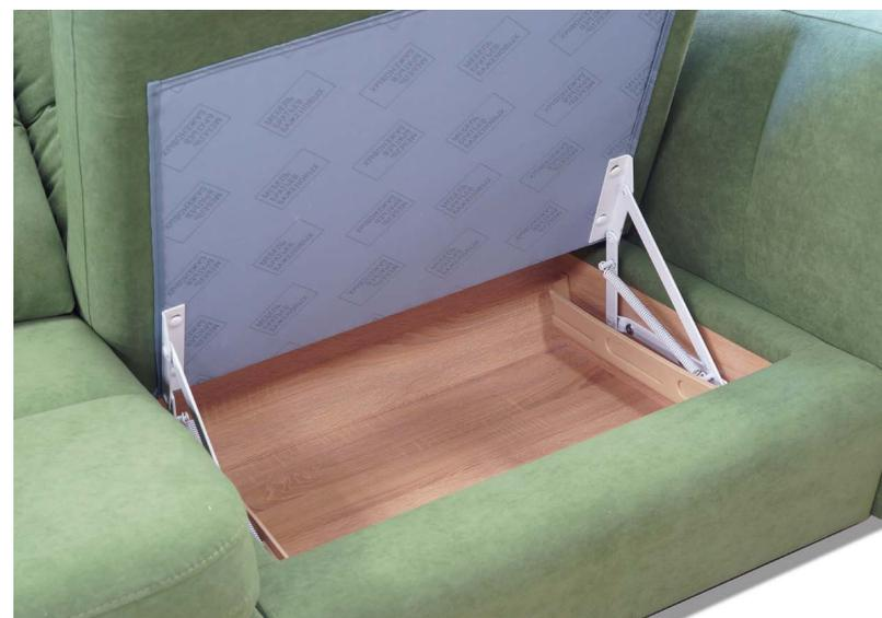
Для подъема сидений используются усовершенствованные механизмы. Крепления рычагов выполнены с использованием износостойких инновационных фторопластовых втулок ❶. При таком креплении отсутствует соприкосновение металла с металлом, что исключает трение и образование металлической крошки, а также появление звуков при работе механизма. Такое решение позволило улучшить комфорт при использовании механизмов, подъем сидений происходит плавно и тихо. Срок службы механизма стал значительно больше.
