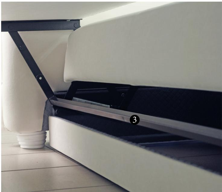
Благодаря установленным на механизм пружинам, трансформация осуществляется легко, они помогают раскладывать диван и сводят Ваши усилия на минимум. Узел фиксации пружины усовершенствован использованием инновационного материала. Пружина крепится на механизм через специальную втулку **2** из фторопласта, которая исключает трение металла о металл, защищает от износа и исключает появление характерных для пружин звуков.
