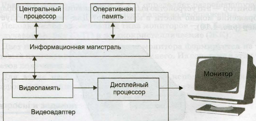
Рис. 4.9. Схема системы вывода изображения на экран
