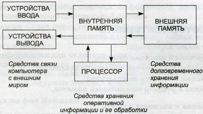
Рис. 2.2. Информационный обмен между устройствами компьютера
