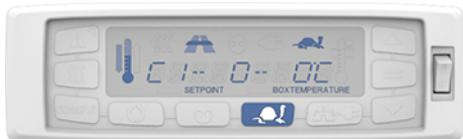
1. Для переключения между режимом только низких оборотов и обычным рабочим режимом нажмите клавишу ГОРОДСКАЯ СКОРОСТЬ (6).
