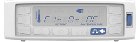
1. Установите переключатель RUN/STOP (3) (Работа/Стоп) в положение RUN (O) (РАБОТА).
