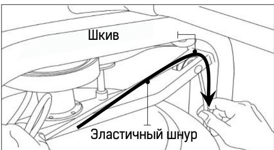
Протяните эластичный шнур через шкив в точности как на рисунке и закрепите на Крюке.
