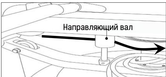
Далее, пропустите ремень вокруг направляющего вала в точности как на рисунке и закрепите на основном валу с помощью липучки. На валу вы найдете специальную выемку для установки конца ремня.
