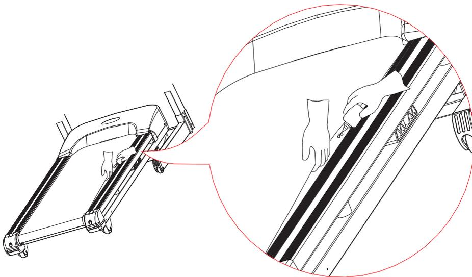
Дека беговой дорожки обрабатывается силиконовой смазкой на Заводе-Изготовителе. Тем не менее, в процессе эксплуатации происходит стирание и высыхание фрикционного слоя смазки. Рекомендуем периодически проверять состояние смазки для достижения наилучших эксплуатационных качеств.
