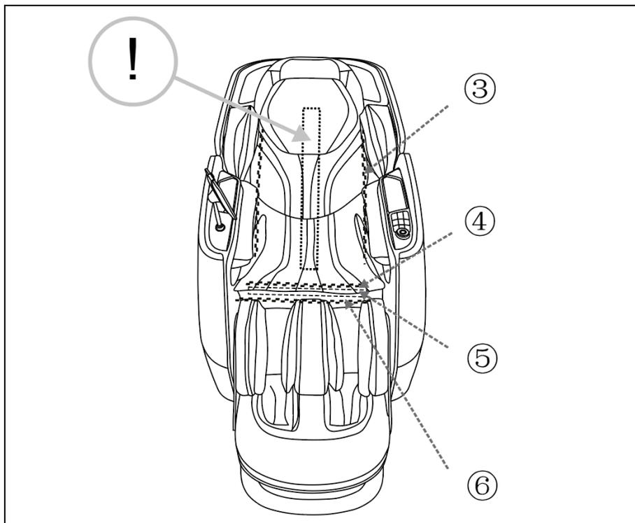
Рисунок 23 — Соединение накидки с корпусом массажного кресла
