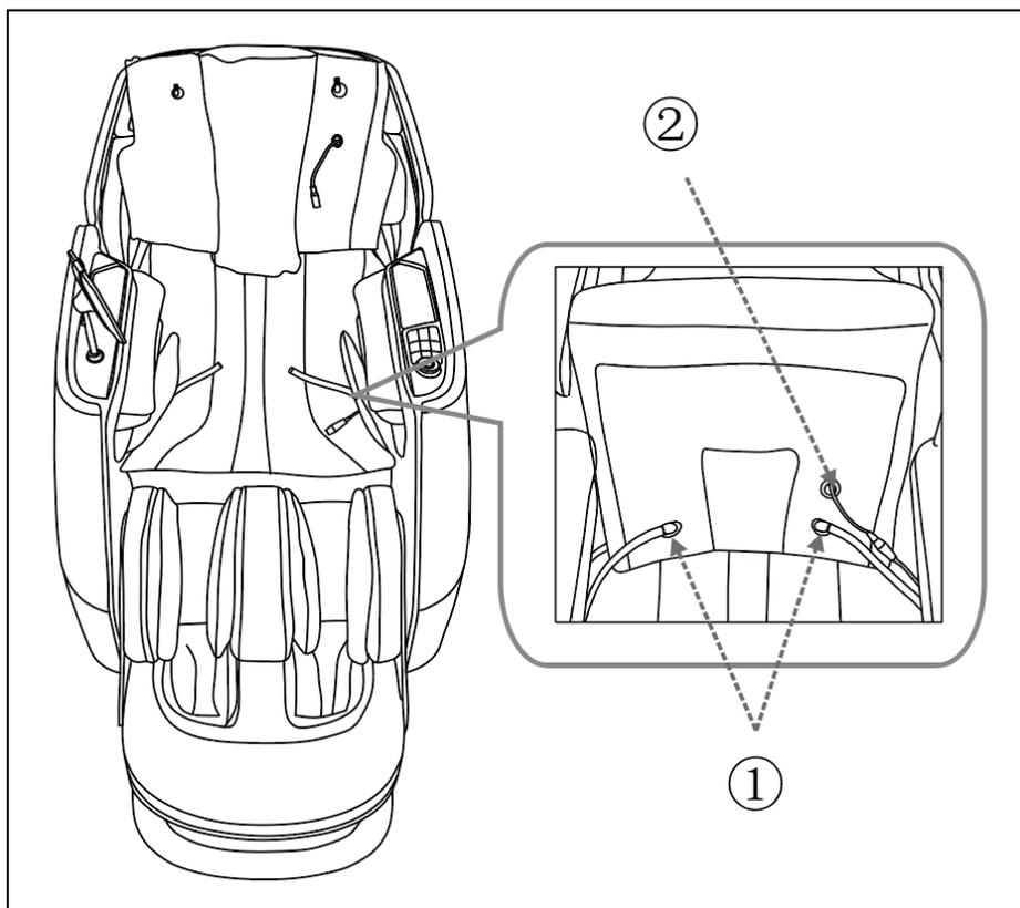
Рисунок 22 — Подключение воздушных трубок к нагревательному проводу
