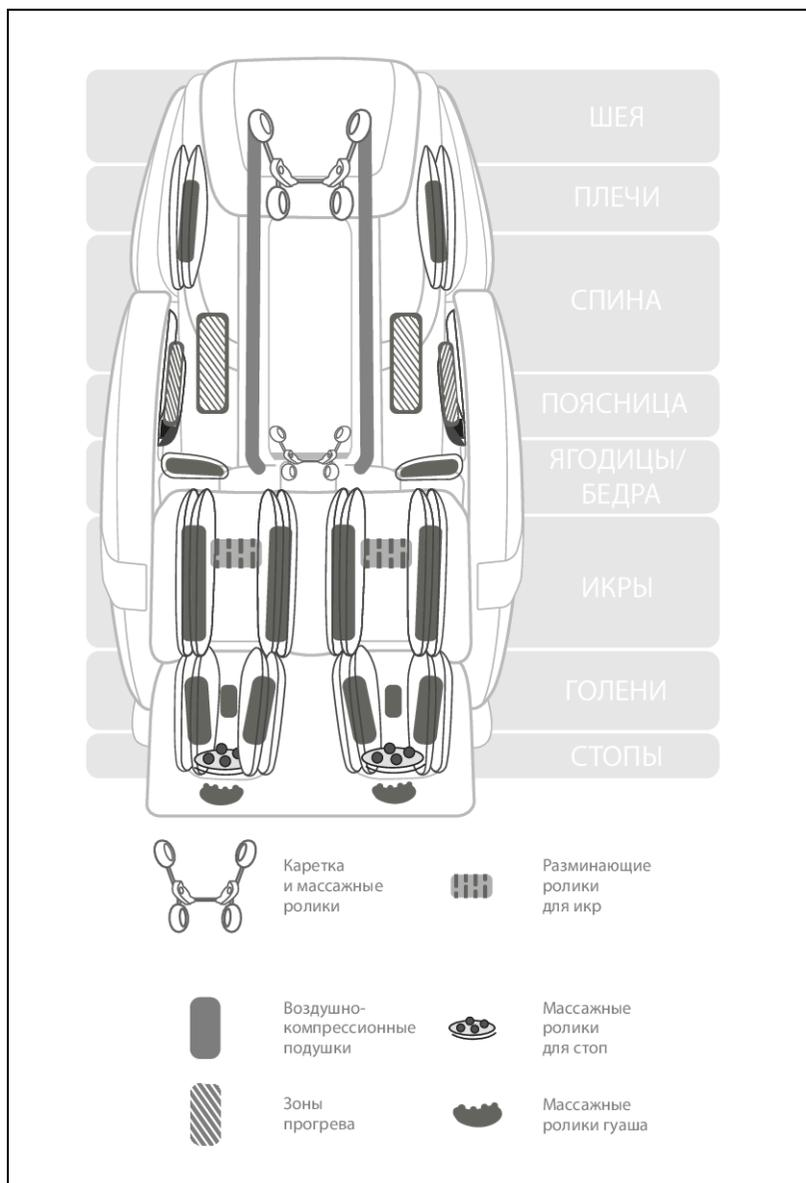
Рисунок 3 — Детали массажного механизма
