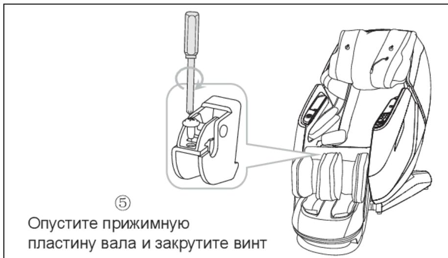
Рисунок 20 — Установка секции для ног
