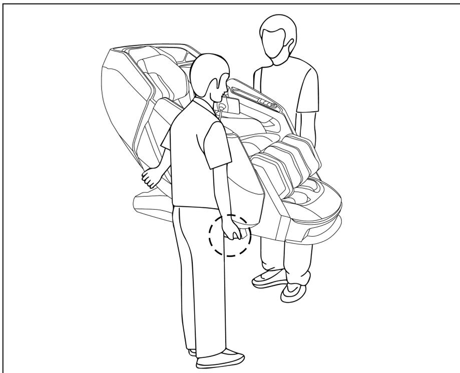
Рисунок 25 — Перемещение массажного кресла без использования транспортировочных роликов
