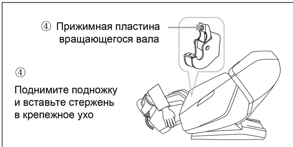
Рисунок 19 — Установка секции для ног
