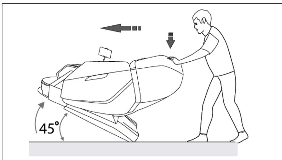
Рисунок 24 — Перемещение массажного кресла с помощью транспортировочных роликов
