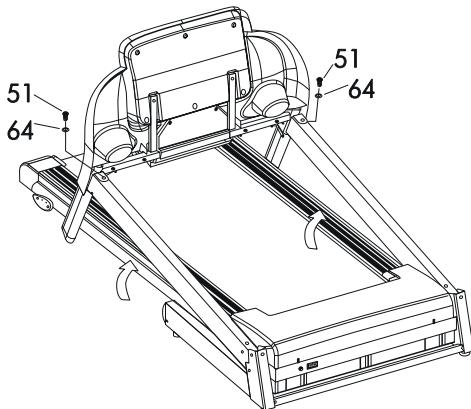
Рисунок 2 – Установка консоли
