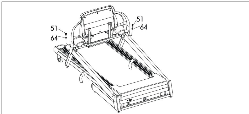
Рисунок 2 – Установка консоли
