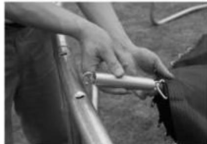
7. Положите прыжковое полотно внутрь каркаса швом вниз и присоедините пружину к одному из треугольных колец на полотне. Затем прикрепите пружину с кольцом к каркасу.
