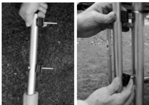
**4. ПРИМЕЧАНИЕ:** надёжно закрепите нижнюю рейку удлинителя ножки винтовым креплением. Затем закрепите винт при помощи гайки.
