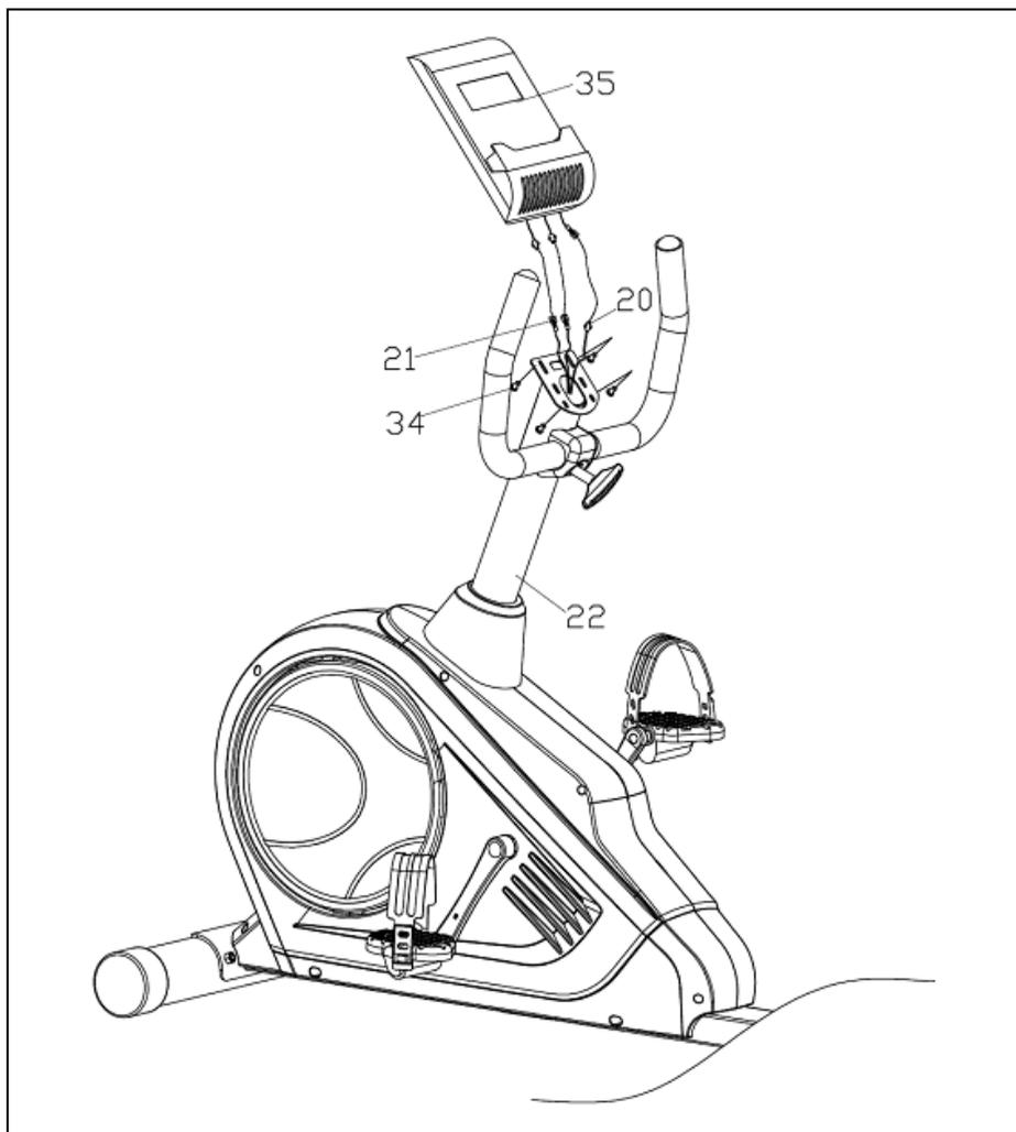
Рисунок 6 – Установка консоли
