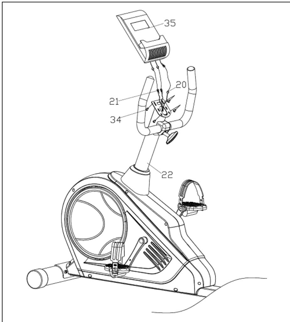
Рисунок 6 – Установка консоли
