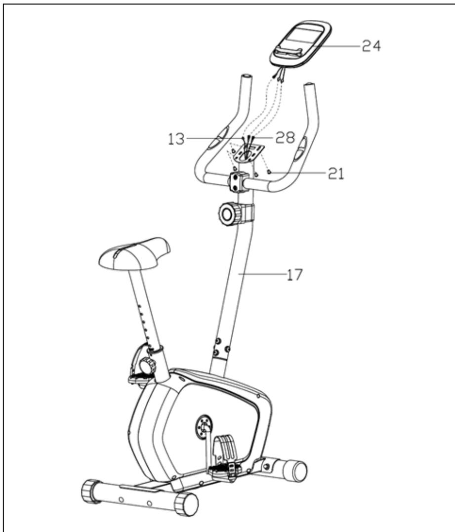
Рисунок 8 – Установка консоли
