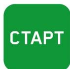
**Старт — кнопка пуска.** При нажатии кнопки через 3 секунды обратного отсчета беговая дорожка начнет движение с минимальной скоростью или скоростью, установленной по умолчанию для выбранной программы.
