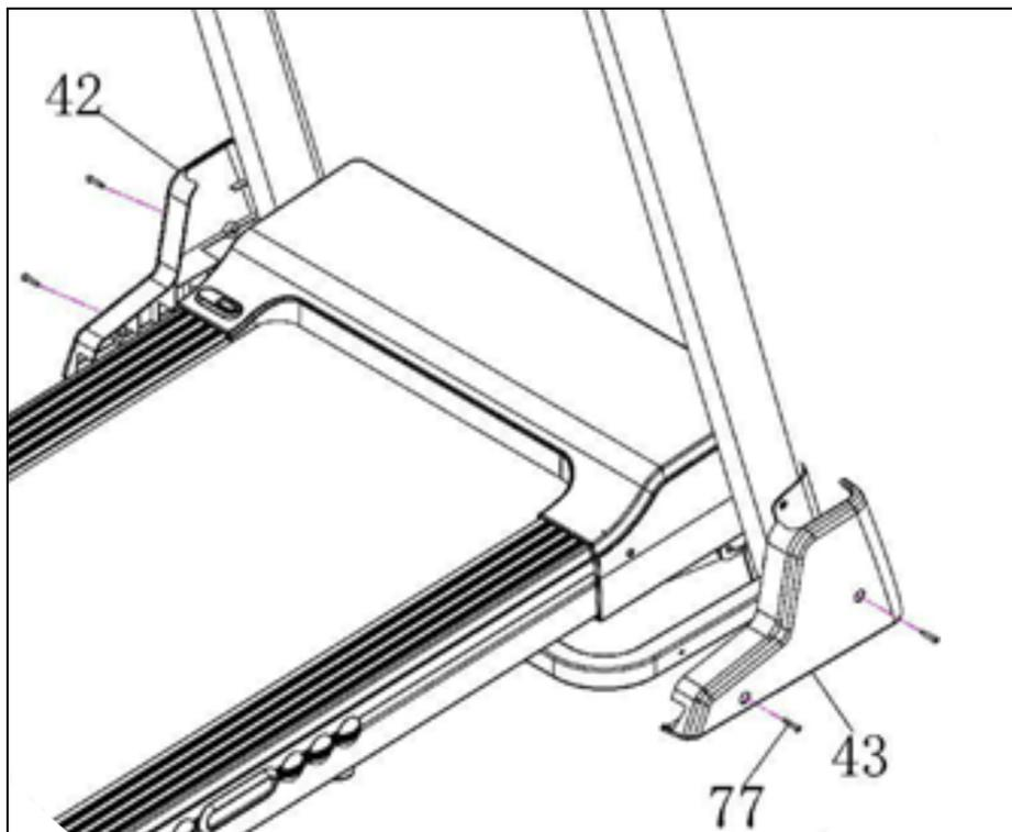
Рисунок 5 — Установка декоративных накладок в основании стоек
