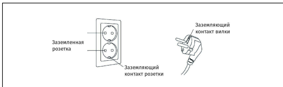
Рисунок 24 — Правильное заземление массажного кресла
