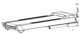
Закрепите кожухи основания (12L/R) на нижней раме (1) при помощи болтов M8\*15 (62) и шайб  $\Phi8*1.2$  (79).
