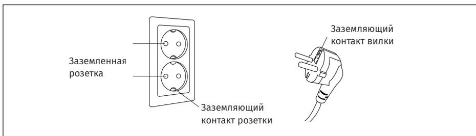
Рисунок 13 – Правильное заземление массажного кресла
