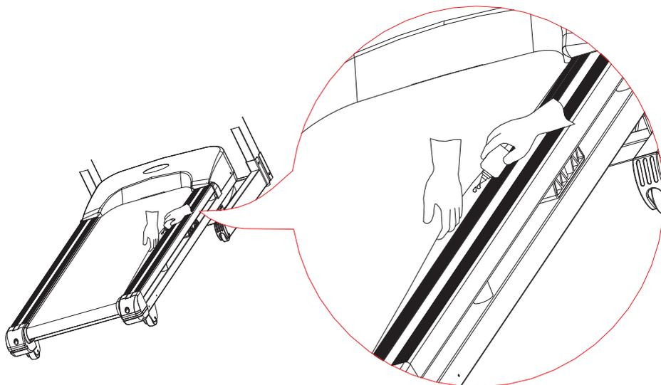
Для снижения нагрузки на электромотор беговой дорожки и более плавного движения полотна его необходимо периодически смазывать силиконовой смазкой. В зависимости от интенсивности использования, периодичность смазывания может изменяться. После начала использования беговой дорожки рекомендуется наносить смазку не позднее, чем после первых 25 часов использования (30-40 мл смазки). В среднем, рекомендуется наносить новую смазку ежемесячно.
