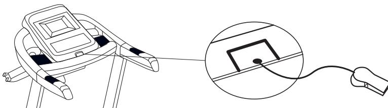
Рисунок 3 – Установка ключа безопасности
