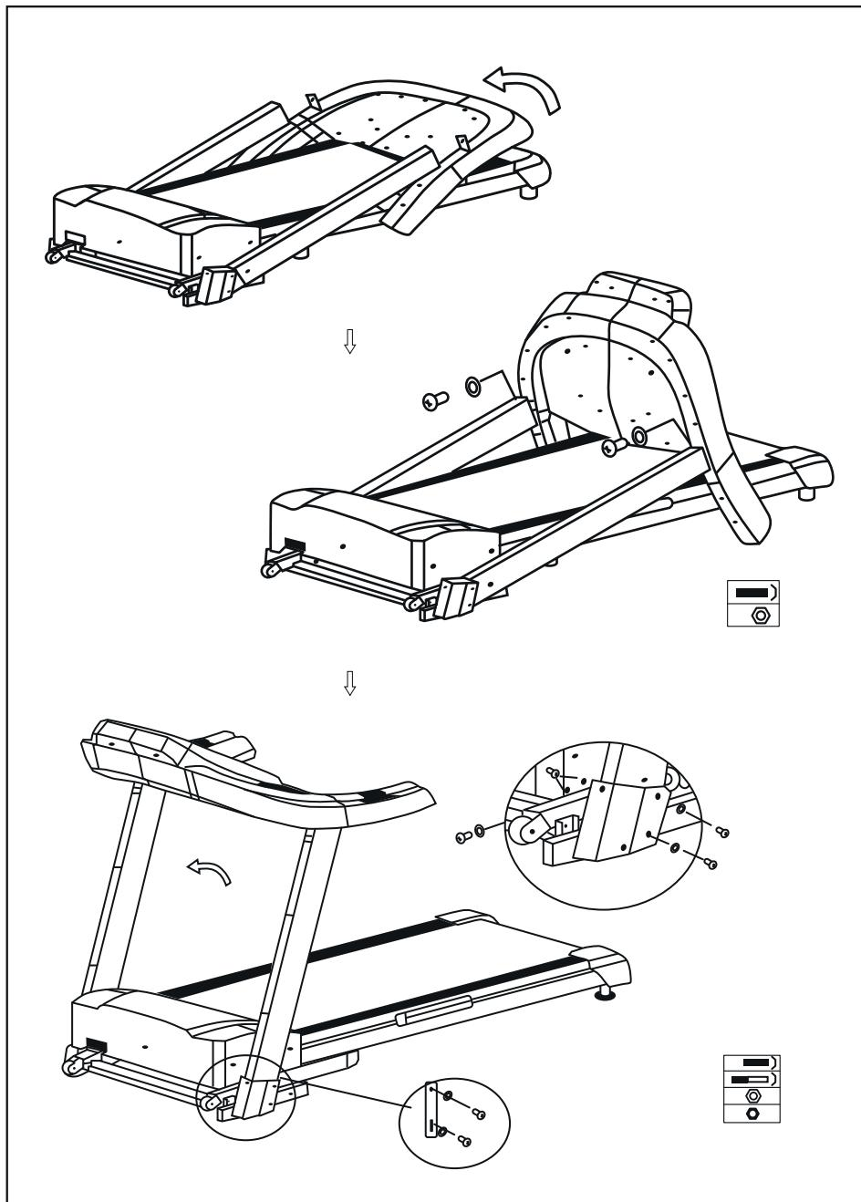
Рисунок 1 – Установка боковых стоек и консоли
