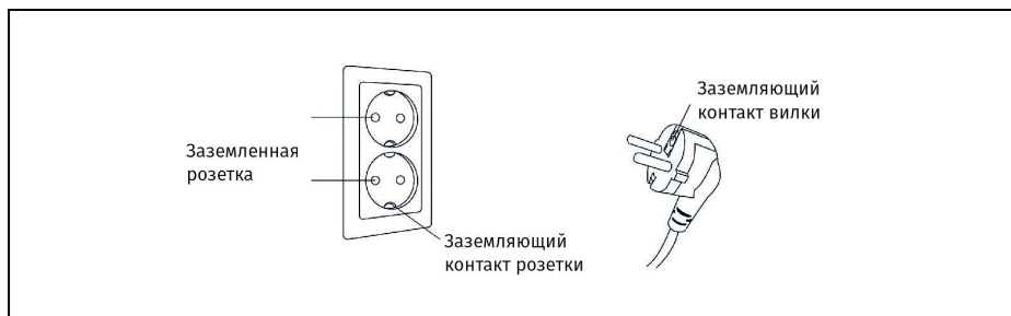
Рисунок 33 — Правильное заземление массажного кресла
