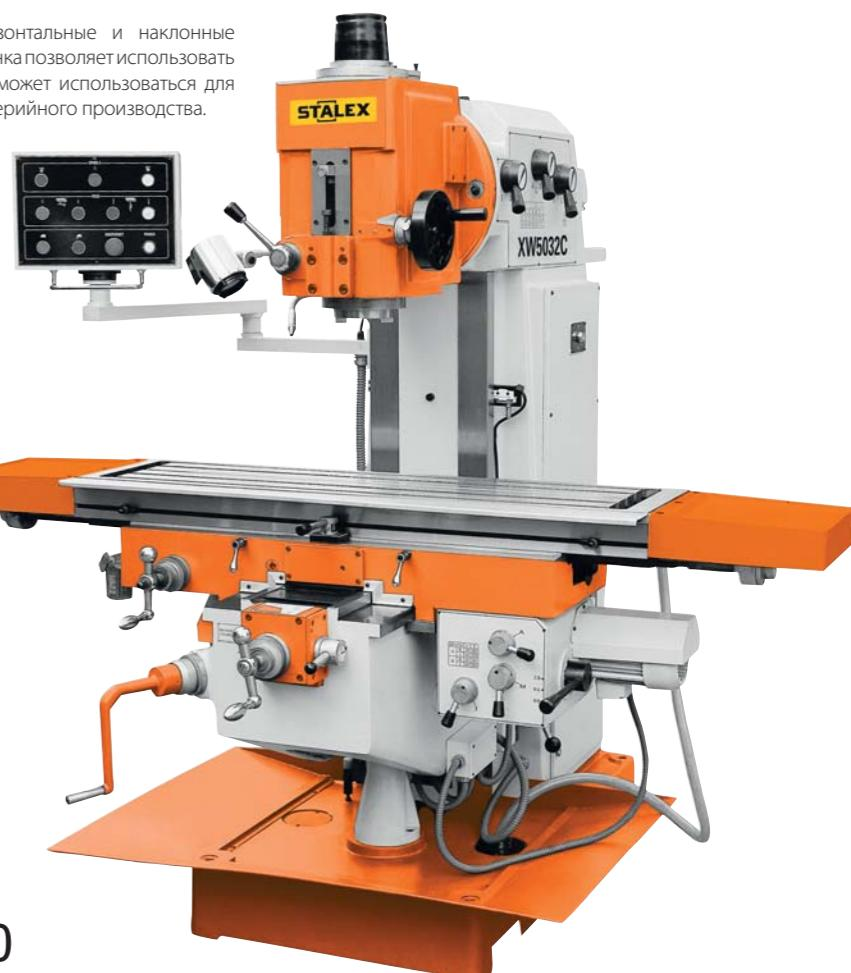
1320x320 Размер стола ISO50 Конус шпинделя
