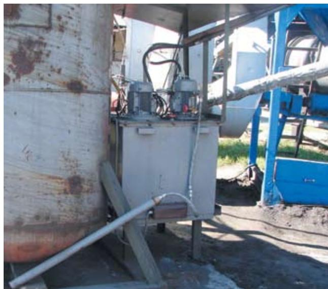
Рис. 4. Установка автоматизированного дозирования ПАВ Вязниковское ДРСУ
