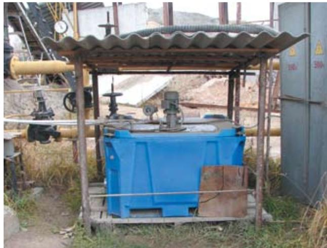
Рис. 3. Установка автоматизированного дозирования ПАВ Меленковское ДРСУ
