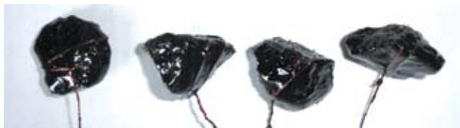
Рис. 1. Гранитный щебень, обработанный битумом с добавкой 0,8% «АЗОЛ 1001» после 30 минут кипячения в воде
