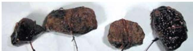
Рис. 2. Гранитный щебень, обработанный битумом без ПАВ после 30 минут кипячения в воде
