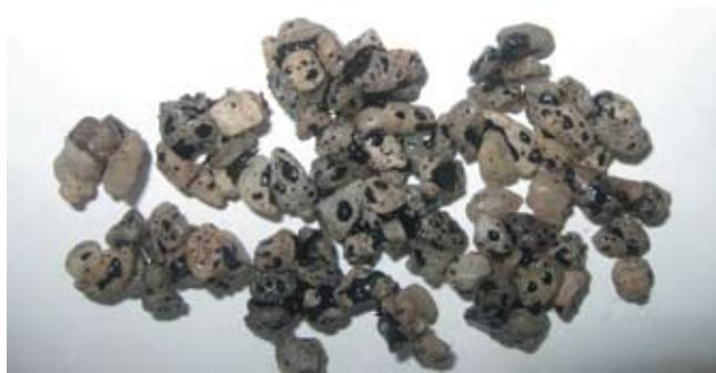
**Рис. 6. Песок обработанный битумом без ПАВ после 30 минут кипячения в воде (увеличено)**
