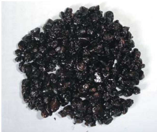
**Рис. 5. Песок обработанный битумом с добавкой 0,8% «АЗОЛ 1003» после 30 минут кипячения в воде**
