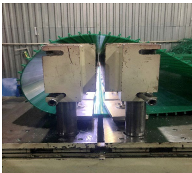
СТЫКОВАЯ СВАРКА НАГРЕВАТЕЛЬНЫМ ЭЛЕМЕНТОМ
