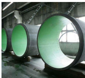
БЕТОННЫЕ ТРУБЫ, ФУТЕРОВАННЫЕ ПОЛИМЕРНЫМ ЛИСТОМ
