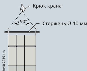
Транспортировка краном с помощью стержня
