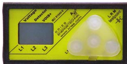
Рисунок 27: VOIS+: Гнёзда для измерения закрыты заглушкой
