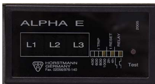
Рисунок 35: Индикатор короткого замыкания ALPHA E, производитель Horstmann
