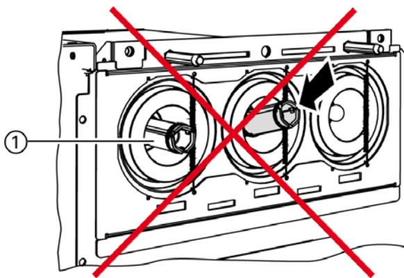
Рисунок 116: Неправильно установленные контактные элементы
