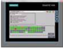
Диагностика AS-Interface с помощью панели HMI
