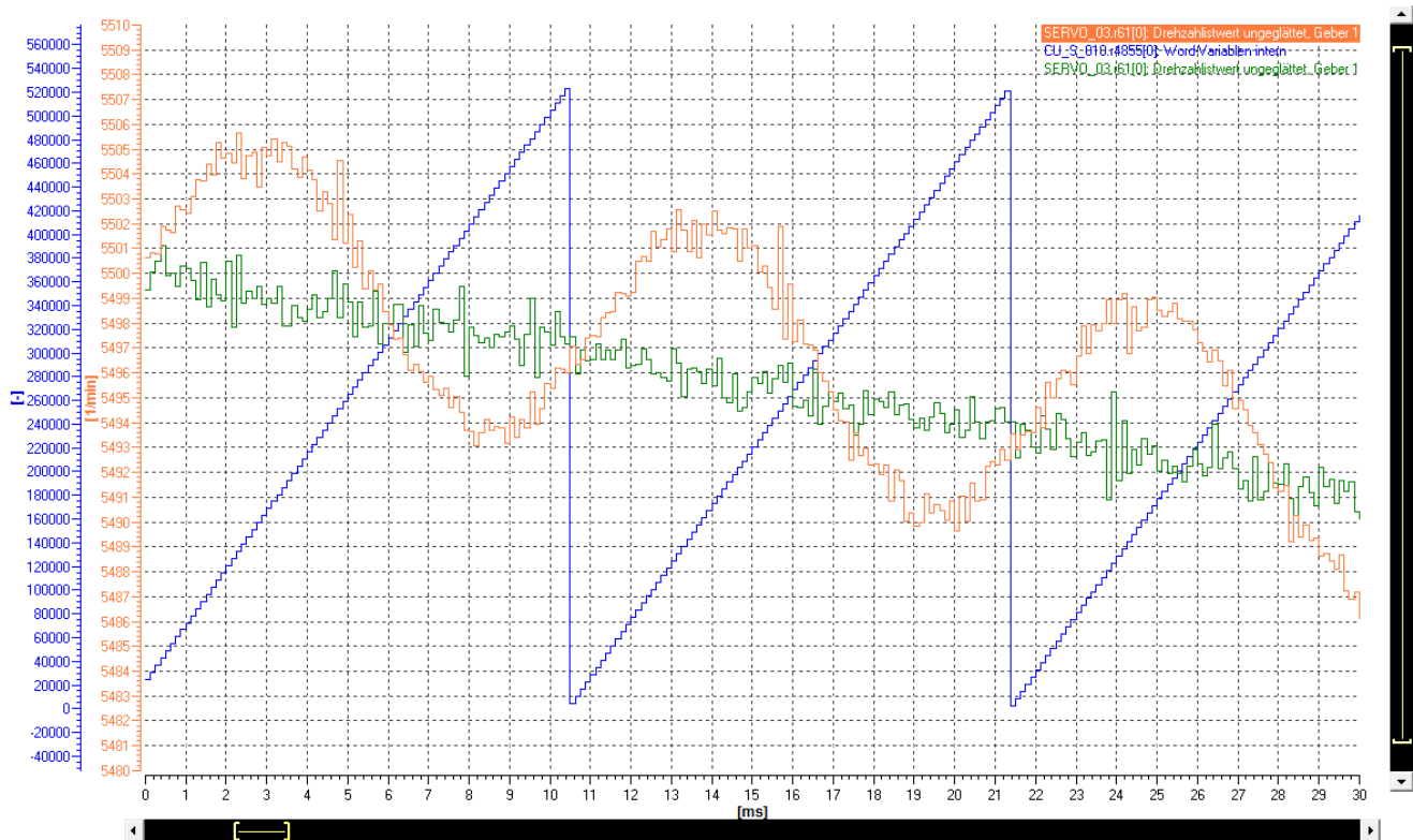
Рисунок 8-53 Частота вращения до и после компенсации
