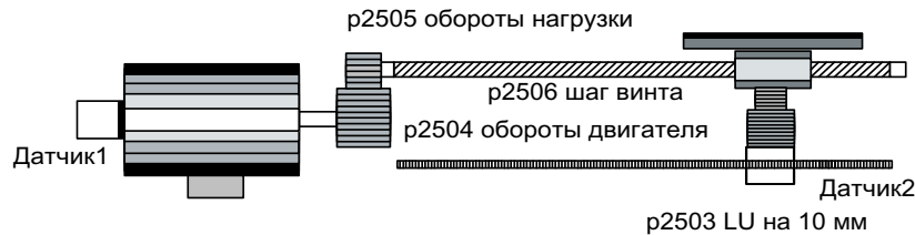
Рисунок 8-7 Регистрация фактического значения положения с линейными датчиками
