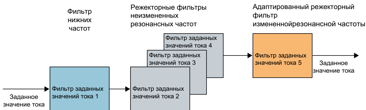
Рисунок 4-12 Пример: фильтр заданных значений тока 5 — последний использованный фильтр в каскаде
