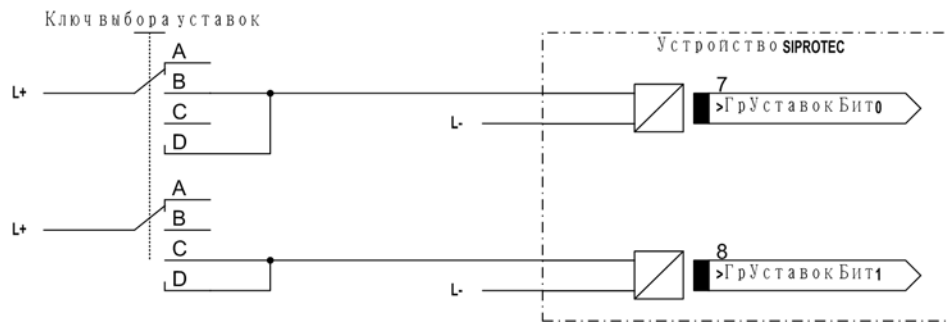
Рисунок 3-1 Схема подключения (пример) изменения групп уставок через дискретные входы
